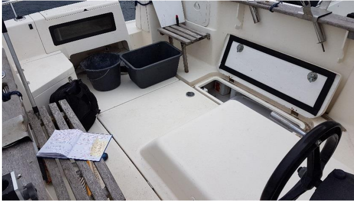
Figur 5: Arrangementet med dreneringskanalar rundt lukekarmene. Foto: SHK
