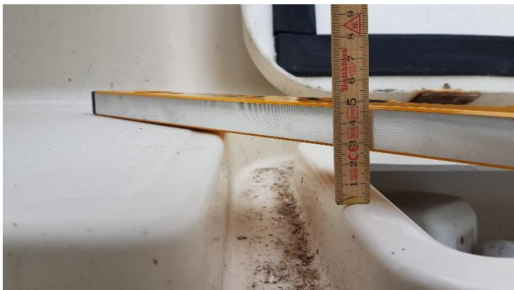
Figur 3: Toppen av lukekarmane er 25 mm lågare enn overflata på dekket rundt. Foto: SHK
