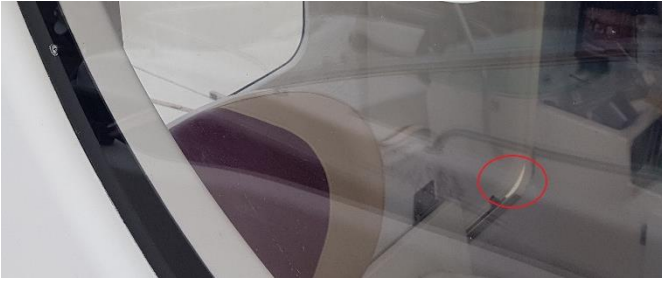
Figur 9: Innsida av styrehusdøra sett gjennom vindauget – tydeleg glipe (raud ring). Foto: SHK
