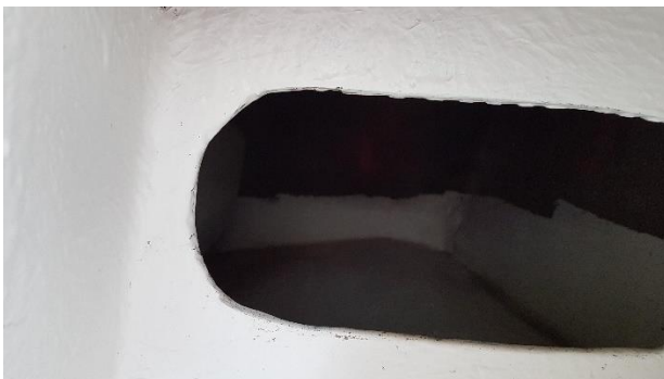
Figur 21: Opning i akterskott i «lasterommet» – ein kan sjå delar av botnen og sida på skroget og akterspegelen gjennom opninga. Foto: SHK
