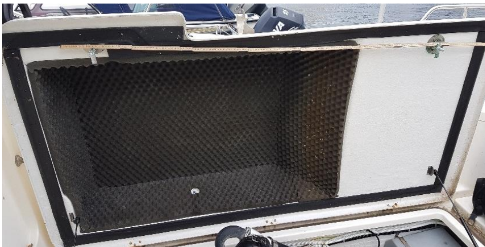
Figur 7: Motorromsluka med to skalkingsbeslag med ein avstand på 1270 mm på éi side. Foto: SHK
