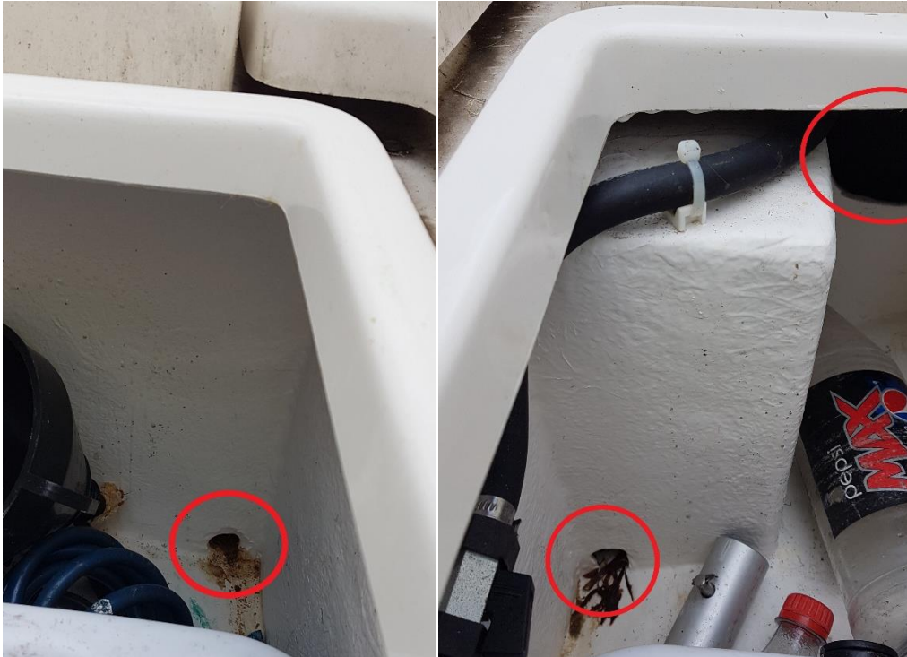
Figur 20: «Lasterom» – venstre bilete: opning i framre skott, høgre bilete: opningar i aktre skott. Foto: SHK
