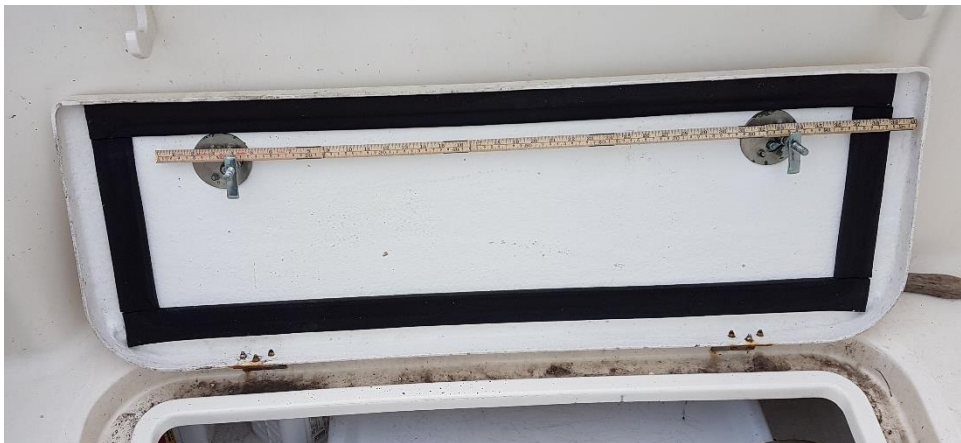
Figur 6: «Lasteromsluka» med to skalkingsbeslag med ein avstand på 750 mm på éi side. Foto: SHK
