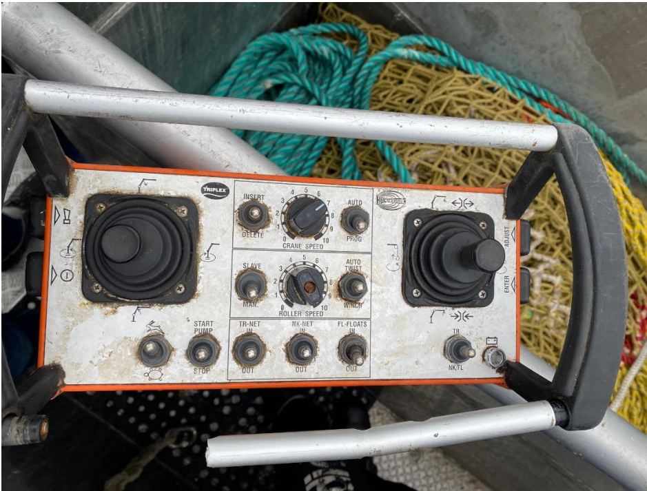
Figur 4: Styringsenhet for notleggeren. Bildet er tatt to dager etter at ulykken fant sted. Hastighet på selve kranen var stilt inn på hurtig (hare). Rullehastigheten på rullen var innstilt på maksimal. Forklaring av de forskjellige bryterne blir gitt i senere avsnitt. Foto: Sjøfartsdirektoratet
