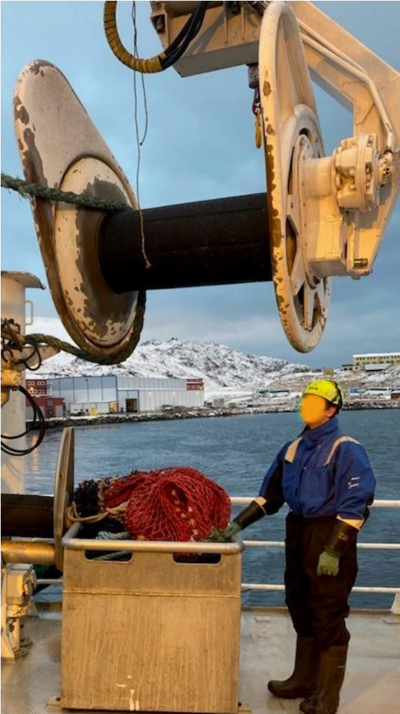
Figur 9: Etter ulykken ble de høye sekkebingene erstattet med en lav. Dette medførte at besetningen kunne stå på dekket. Rulleleggeren kunne ikke komme lenger ned over sekkebingene enn det som er vist på figuren og dermed var det ikke lenger fare for at rullen kunne påføre mannskapet skade i denne posisjonen. Foto: Rederiet
