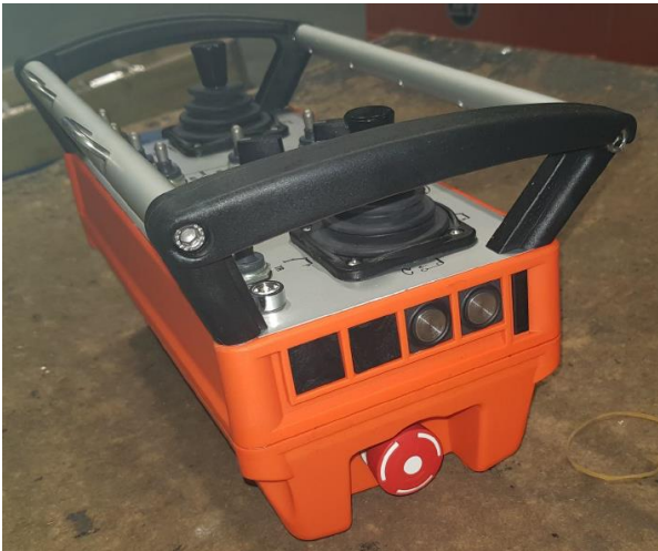
Figur 7: Nødstop kan aktiveres fra styringsenheten. Nødstoppbryteren var på høyre side av styringsenheten. Foto: Kranprodusenten
