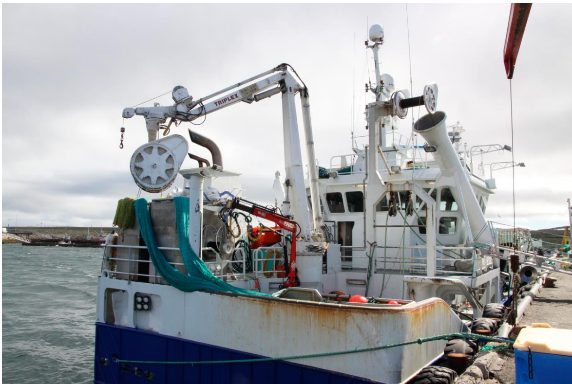
Figur 2: Fiskefartøyet sett aktenfra. Bildet ble tatt i etterkant av ulykken. Snurrevadnotene ligger i bingje på hoveddekket. Den ene sekken (grønn) ligger ut fra sekkebingjen på babord side. Notleggeren, som består av kran og rull, henger like over de to høye sekkebingene på babord side. Den forulykkede ble klemt av rullen til notleggeren da han stod mellom sekkebingene. Det som kalles for triplex i rapporten er på styrbord side av styrhuset, foran det skråstilte notrøret som vises i bildet på høyre side. Foto: Politiet
