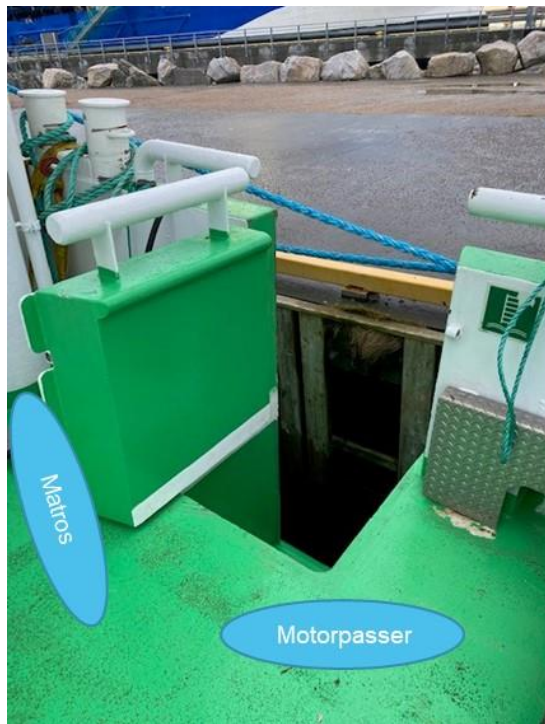
Figur 3: Sannsynlig plassering av motorpasser og matros like før ulykken. Rekkeporten var enda mer åpen på ulykkestidspunktet. Foto: SHK
