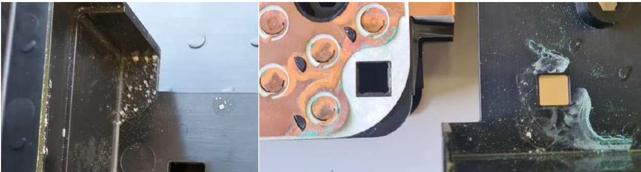
Figur 48: Bildet til venstre viser uttørket krystallisert salt inne i streng 12, modul 5, celledmodul 2. Bildet til høyre viser synlig korrosjon og saltvannsrester på databuss og celledmodulcover i streng 12, modul 4, celledmodul 4. Foto: Batterileverandøren
