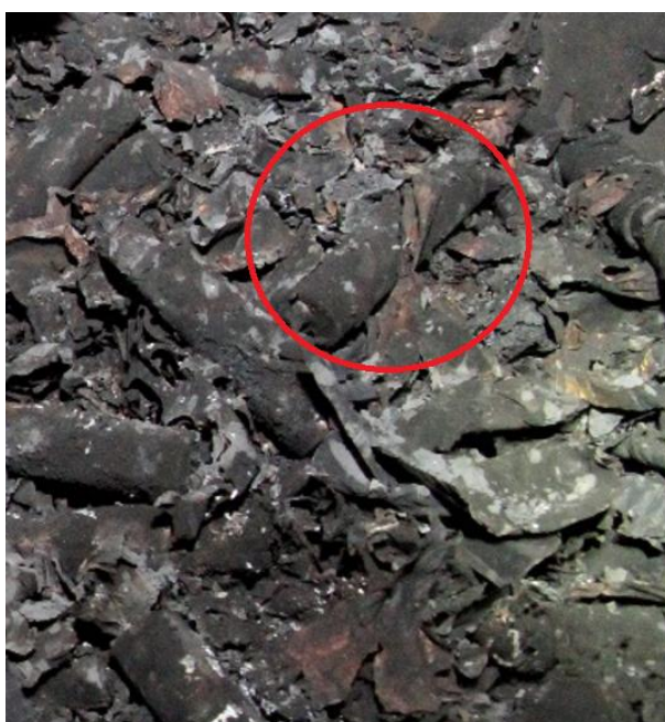
Figur 35: Rød sirkel indikerer tegn til brudd i battericelleveggen. Foto: Kripos
