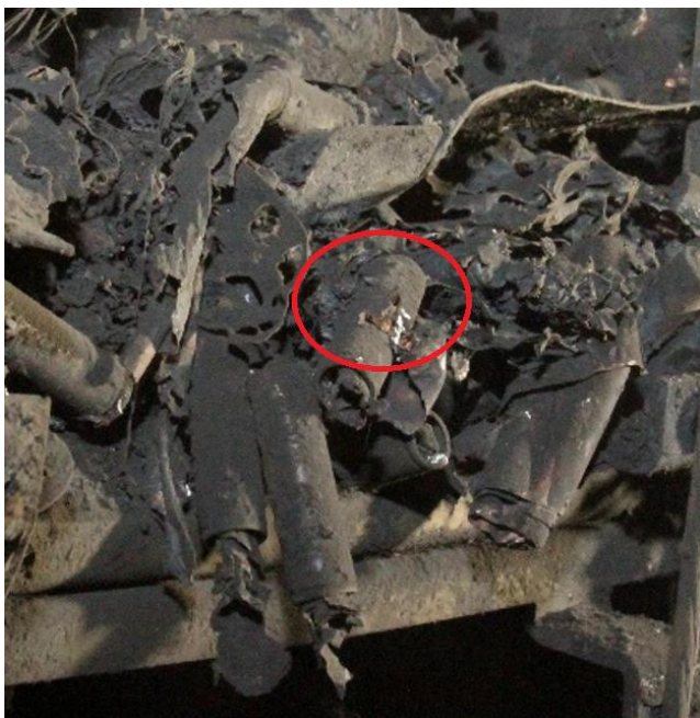
Figur 34: Rød sirkel indikerer tegn til brudd i battericelleveggen. Foto: Kripos
