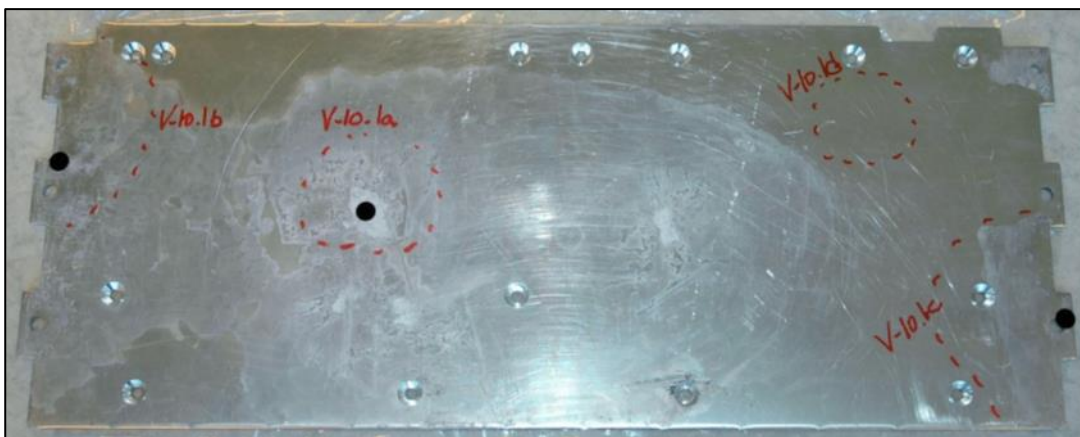
Figur 40: Bunnplaten til strengkontrolleren. Markerte områder fra der avskrapninger ble tatt og sendt til analyse. Foto: SHK
