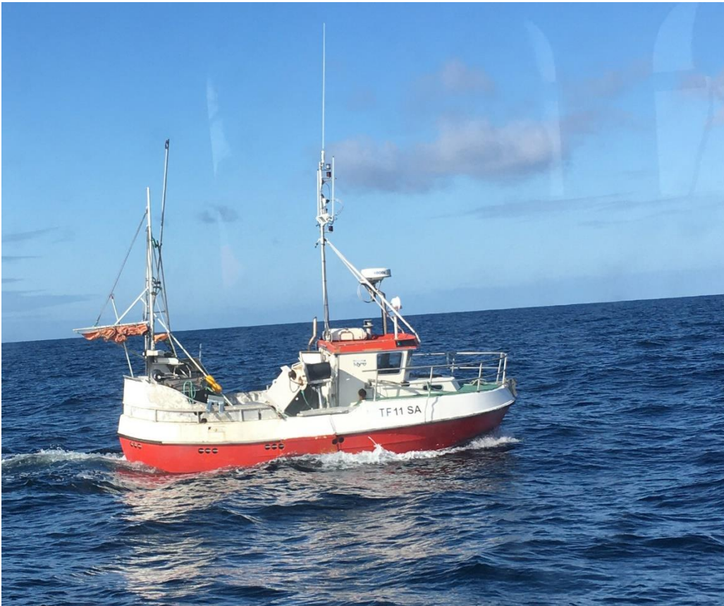
Figur 3: Biletet viser Sørbris på veg mot Finnmarken våren 2020. Ein kan sjå at det er gjort store endringar i arrangementet om bord samanlikna med figur 2. Ein ny garnhaler står montert +/- 1,5 meter over, og det er montert ein nyare garngreiar lenger akterover. Redningsflåten er synleg på styrehustaket. Foto: Privat
