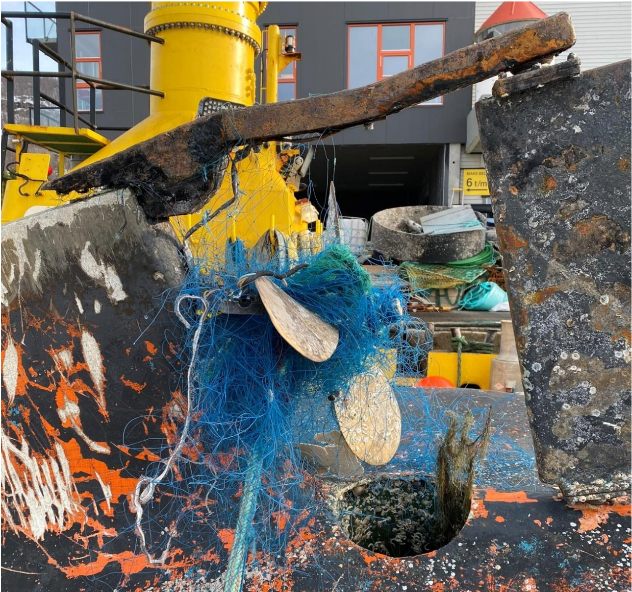
Figur 7: Etter at fartøyet var heva, blei det klart at Sørbris hadde fått delar av bruket rundt propellvengene og akslingen. I akterkant av propellen ser ein propellsjakta, som kan gje den som er om bord, ei moglegheit for å kome til med ein ljàkniv for å skjere slikt laust. Foto: SHK
