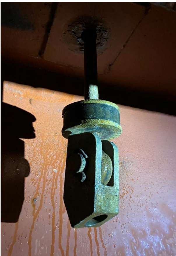
Figur 9: Ters plassert under skinnegangen for å terser lastelukene til lukekarmen. Foto: SHK
