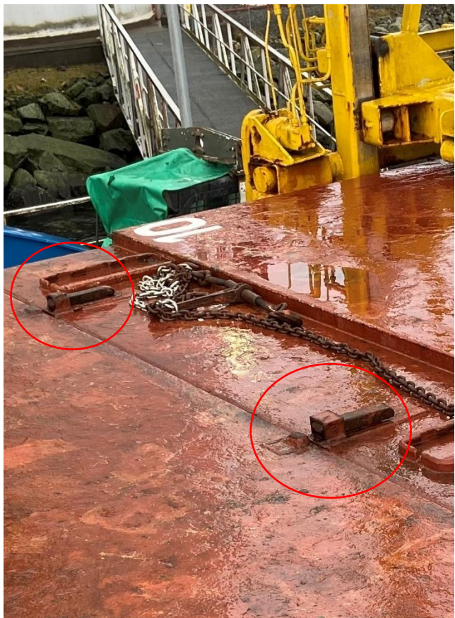
Figur 10: Kiler (se rød ring) som sikrer at hver lasteluke henger sammen med tilstøtende lasteluke. Kjettingen var brukt til å sjøsikre grabben til gravemaskinen. Foto: SHK
