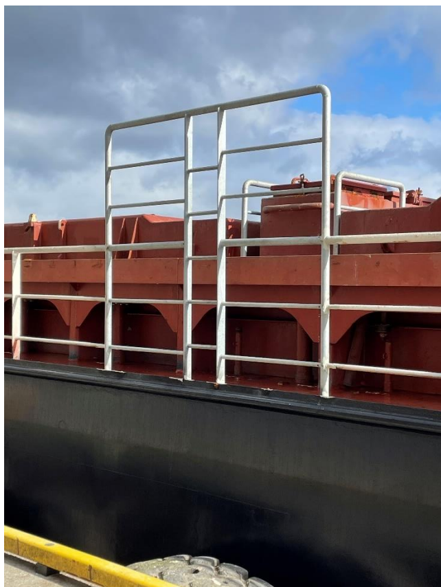
Figur 14: Punktforhøyning av rekkverk på tilsvarende fartøy i rederiet (sett fra kai). Foto: Berge Rederi AS
