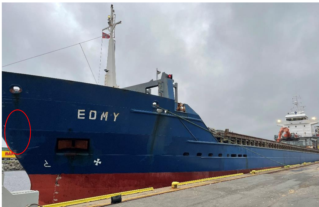
Figur 4: Lasteskipet Edmy fikk kun mindre skrapskader og en liten bulk i baugen. Foto: SHK
