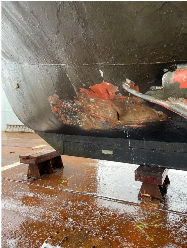
Figur 7: Skader i skroget som førte til vanninntrenging til lasterommet. Foto: SHK
