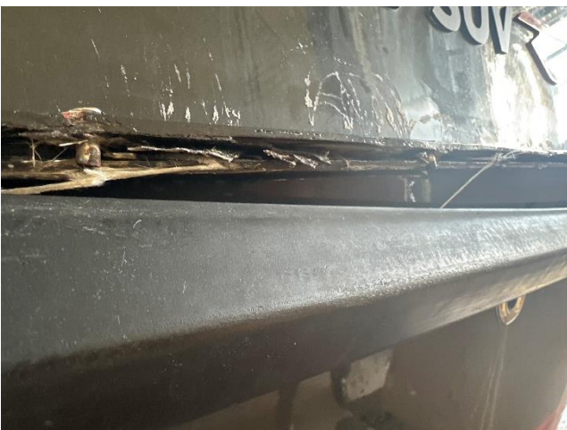
Figur 3: Popnagler ute av posisjon sett fremover. Foto: SHK
