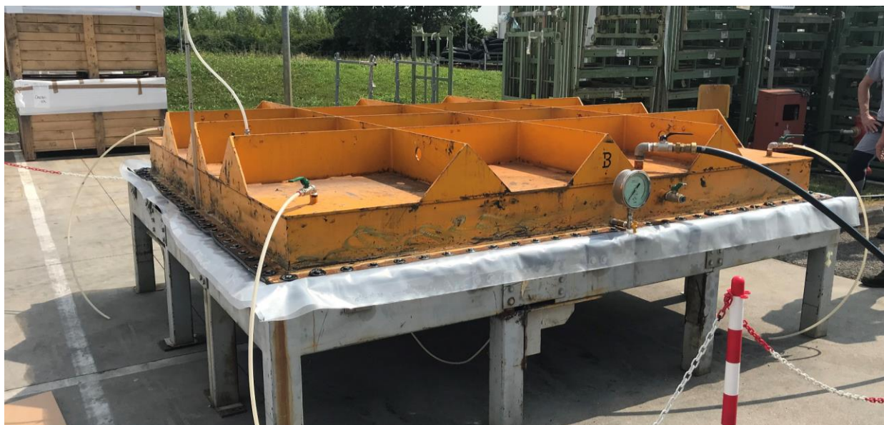
Figur 10-1 Statisk trykktest, bilder fra vindusfabrikant, SOMEC
