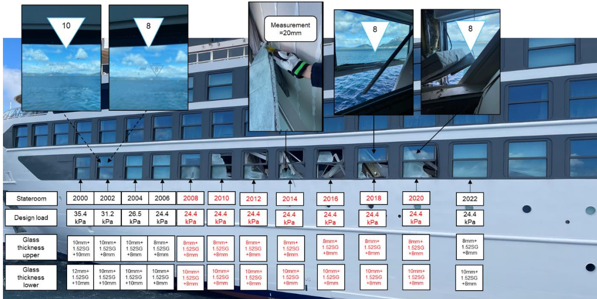
Figur 8-2 Designparametere for vinduene.
