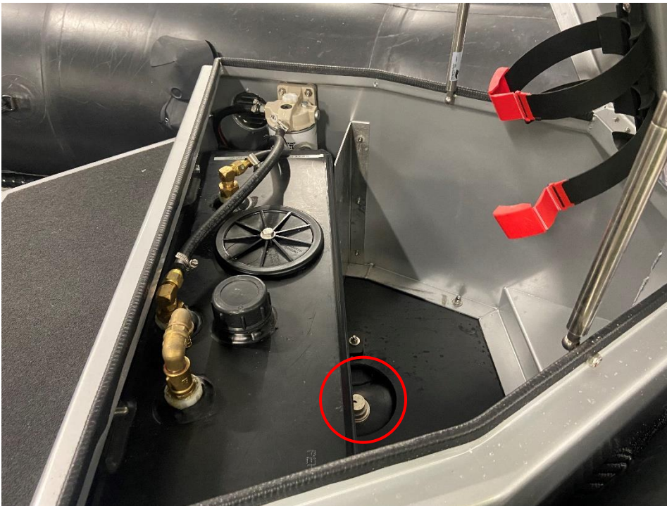
Figur 67: Aluminiumskassen foran i baugen på en av Zodiac-ene. Ventilen til den oppblåsbare kjølen er vist med rød ring. Foto: SHK
