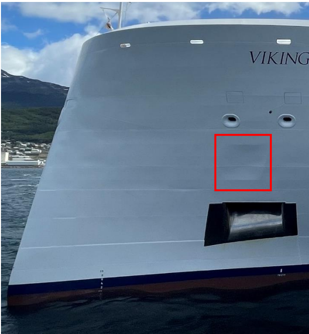
Figur 38: Bulk på babord side i baugen markert med rød firkant, fotografert 05.12.22. Foto: SHK
