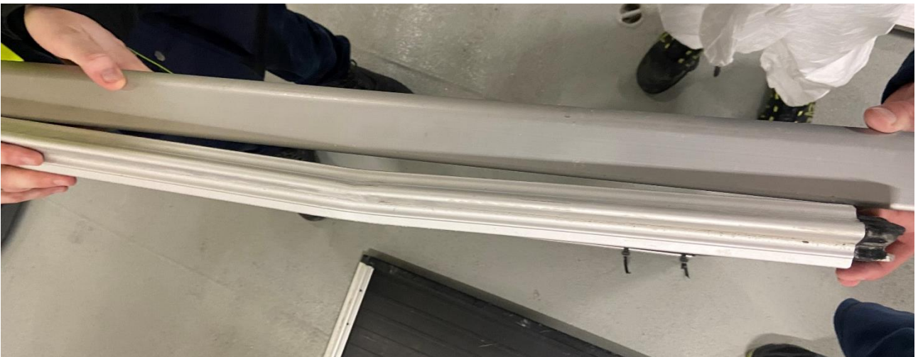
Figur 43: Dørkplatene i det skadede området var bøyd. Foto: SHK
