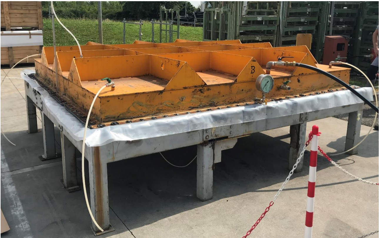
Figur 78: Den hydrostatiske testbenken som ble benyttet til fullskala testen. Foto: Vindusleverandør
