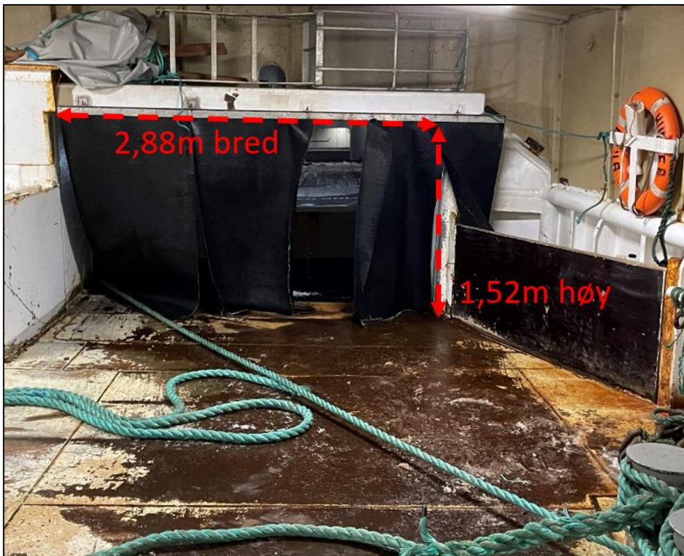
Figur 8: Setteluka på arbeidsdekket akterut. Foto: SHK
