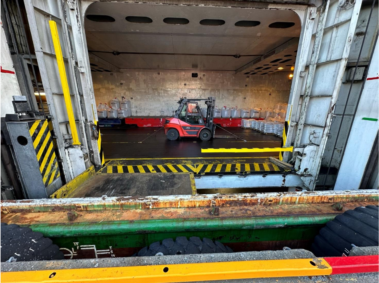
Figur 11: Sideluken med en av palleheisene på øvre lastedekk og en på nedre. Bommen kommer ned når palleheisen ikke er i flukt med lastedekket. Foto: SHK
