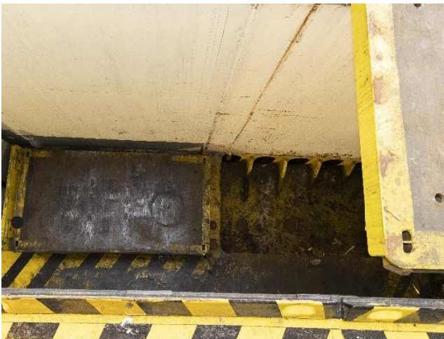
Figur 9: Heissjakten med aktre heisplattform til høyre i bildet, i flukt med øvre lastedekk. Fremre heisplattformen parkert på nedre lastedekk til venstre i bildet. Foto: Politiet
