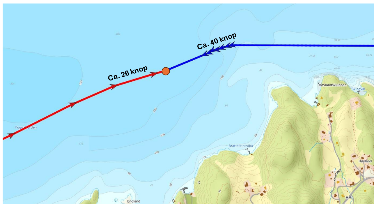
Figur 16: Siste del av fartøyenes seilas før de kolliderte kl. 01:17:06. Oransje punkt viser hvor kollisjonen inntraff. Kart: ©norgeskart.no. Illustrasjon: SHK
