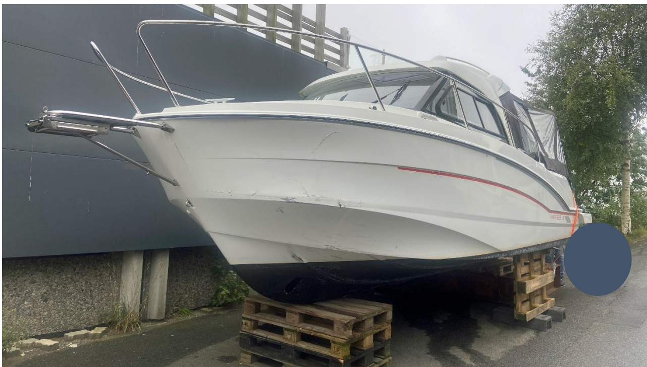
Figur 10: Fritidsbåten med skader på babord side av skroget. Foto: SHK
