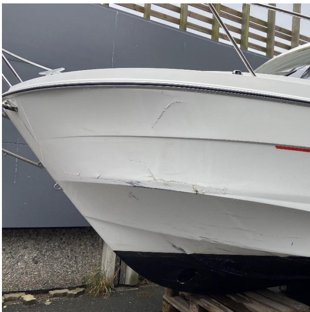
Figur 11: Skader på babord side av skroget. Foto: SHK
