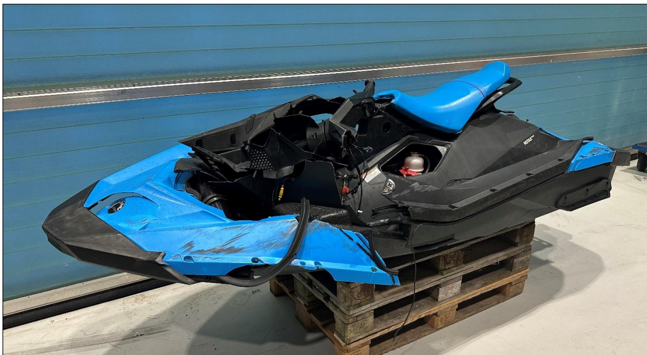
Figur 9: Skader på vannskuterer hvor babord side av styret var brukket av og skroget var delvis knust. Foto: SHK
