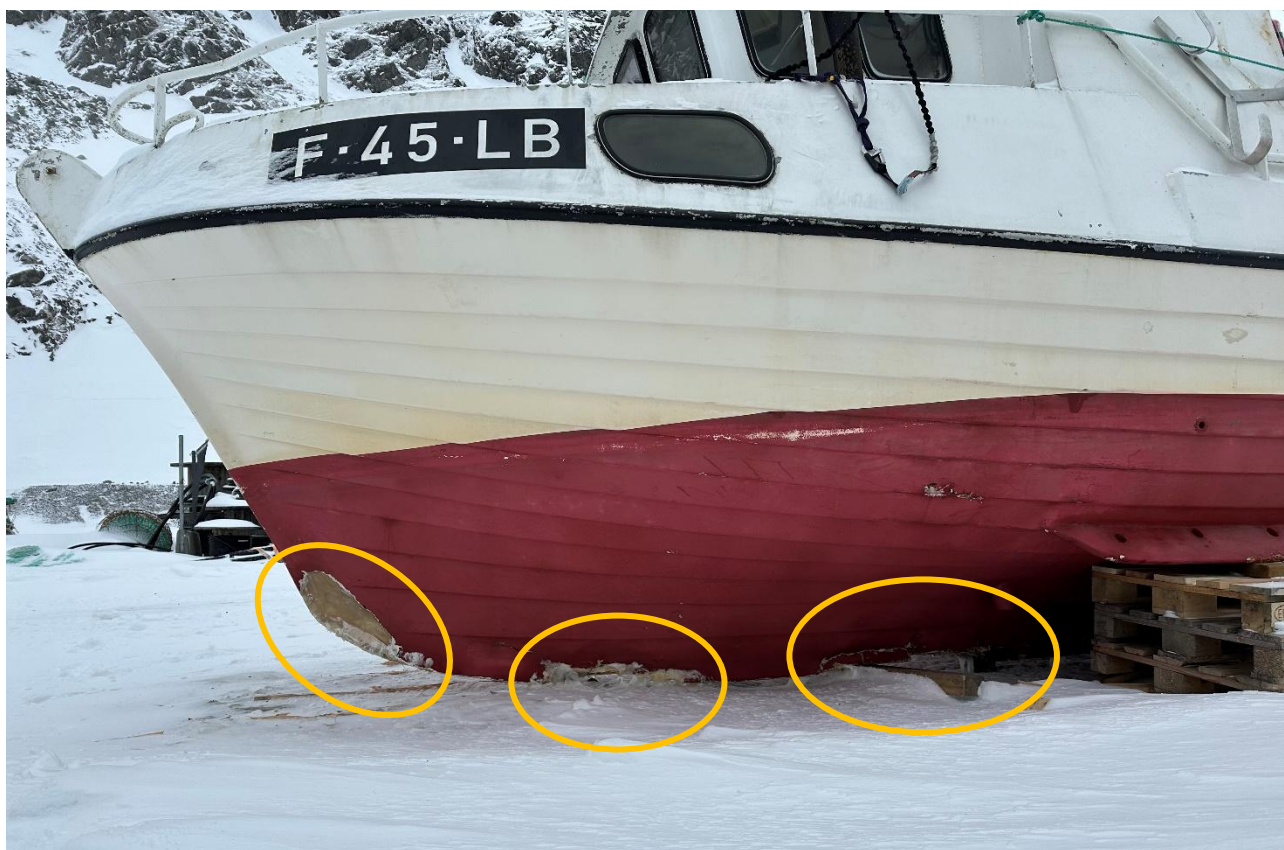
Figur 6: Skader på kjølen med hull gjennom skroget markert med gule ringer. Foto: SHK
