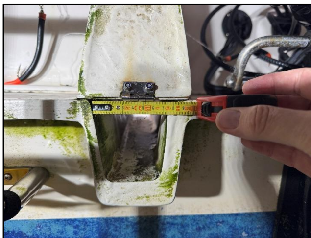
Figur 19: Babord sjøslagport på ulykkesbåten. Foto: SHK
