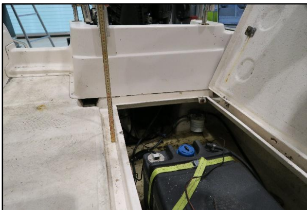
Figur 13: Dreneringskanaler rundt lukekarmen. Foto: SHK
