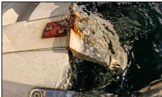
Figur 26: Babord sjøslagport i åpen posisjon som følge av akterlig trim i en bølgedal. Foto: SHK
