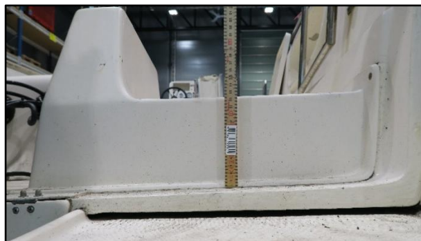
Figur 22: Nedsenket inntrinn på styrbord side akterut som var ca. 12,5 cm over dekk. Foto: SHK
