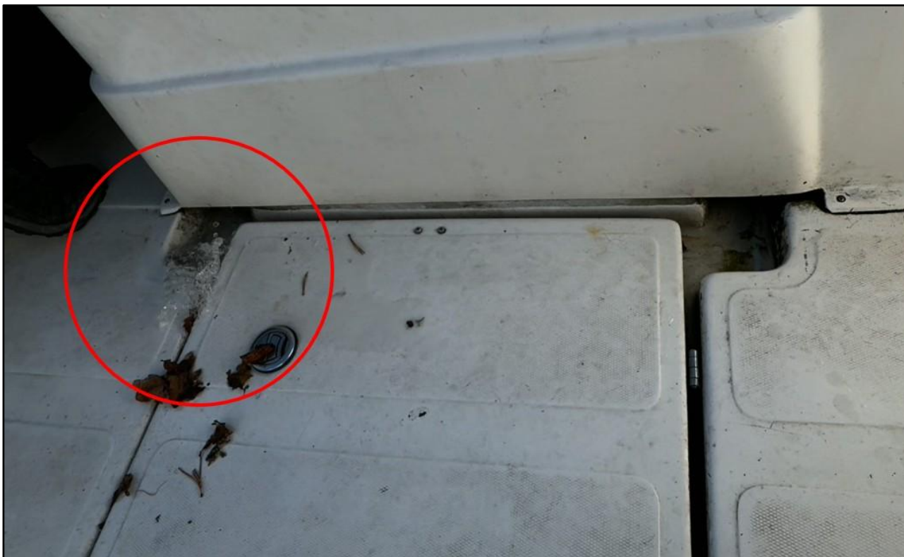
Figur 27: Akterdekket med dreneringskanalen rundt storluken som går sammen med dreneringskanalene ut akterut. Den røde sirkelen viser vann som kommer inn på dekket gjennom styrbord sjøslagport i en sjøtilstand på ca. 0,5 meter signifikant bølgehøyde. Foto og illustrasjon: SHK
