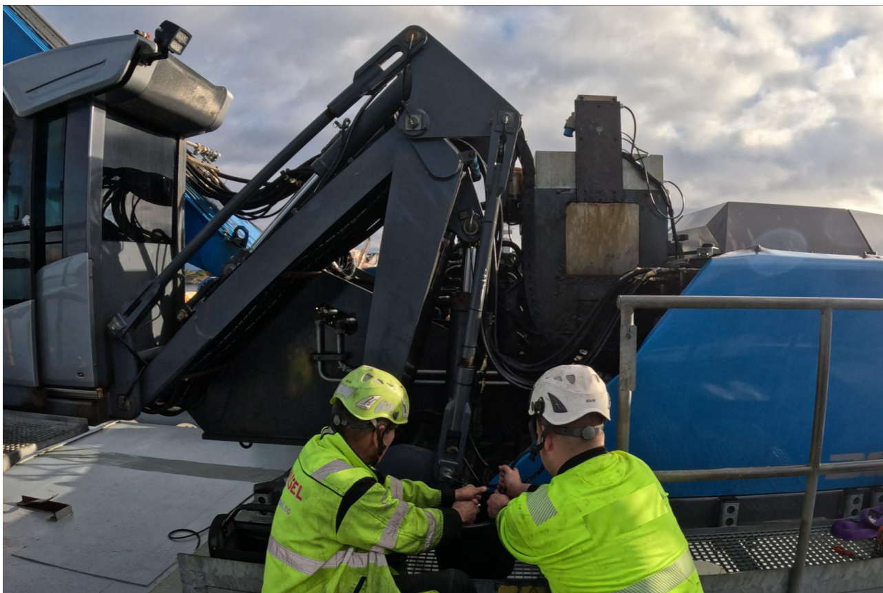
Figur 16: Utgangsposisjon for rekonstruksjonen, løfterammen dannet i underkant av 90 grader mot underlaget. Foto: SHK
