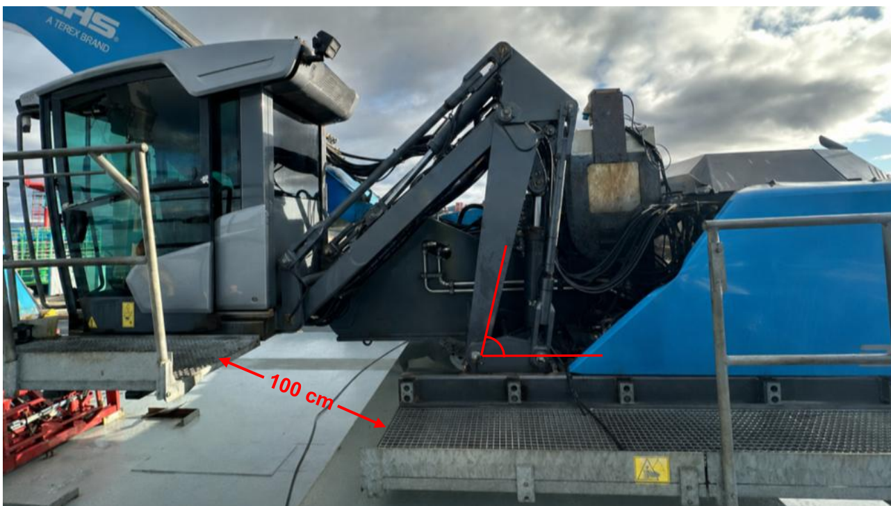
Figur 13: Førerhuset delvis kjørt frem. Avstand mellom de to plattformdelene vist i rødt. Foto: SHK
