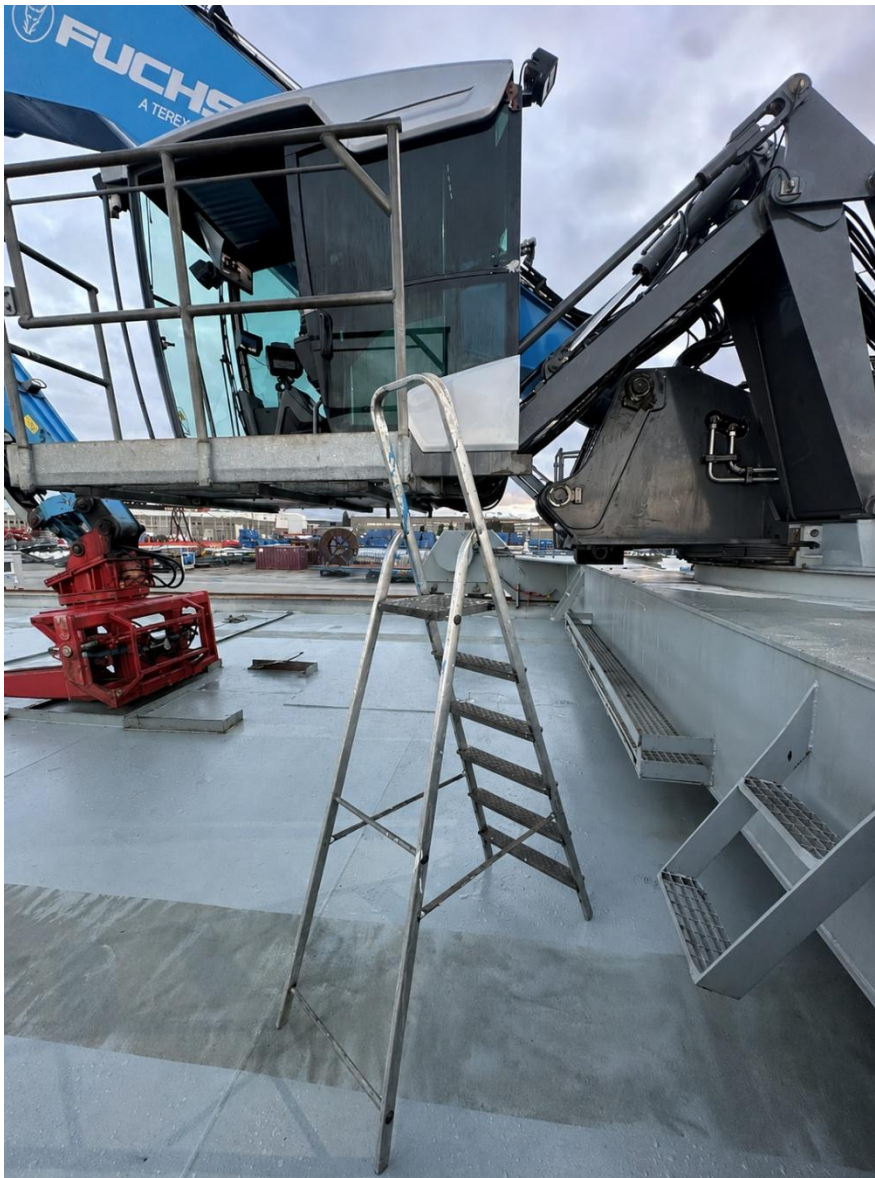
Figur 15: Gardintrapp ved plattformen på utsiden av førerhuset. Foto: SHK
