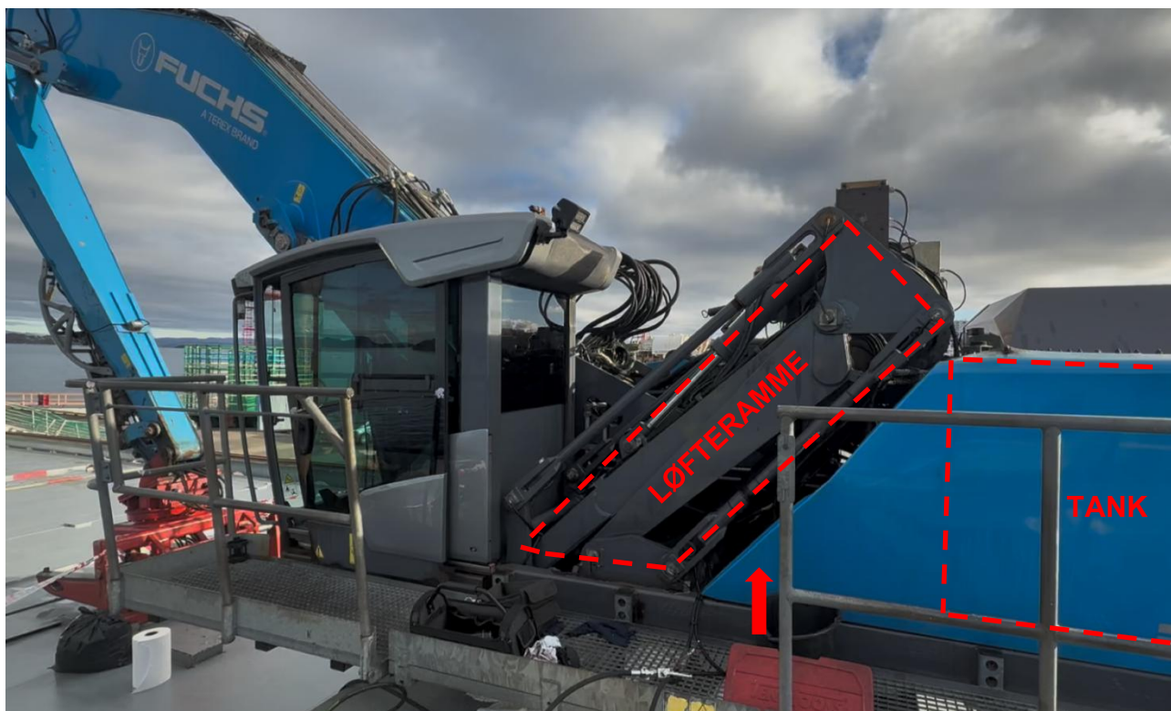
Figur 3: Gravemaskinen i parkert posisjon. Løfteramme og hydraulikkoljetank er markert i rødt. Tanken er plassert bak et blått beskyttelsespanel. Rød pil viser plassering av ventilblokken, bak panelet. Foto: SHK
