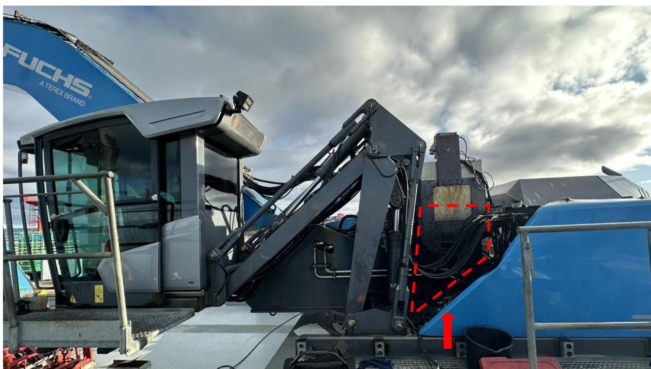
Figur 4: Gravemaskinen med førerhuset kjørt delvis fremover, omtrentlig slik det sto før ulykken skjedde. Området hvor arbeidet skulle foregå er merket med rødt, og rød pil viser plassering av ventilblokken bak blått beskyttelsespanel. Foto: SHK
