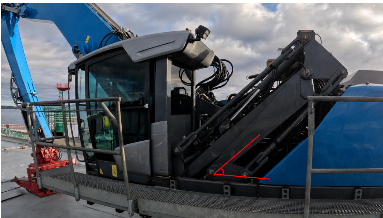
Figur 12: Førerhuset kjørt helt tilbake, i parkert posisjon. Plattform med gangrist langs siden av gravemaskinen. Foto: SHK
