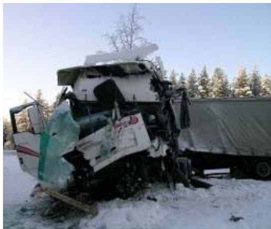
Figur 5: Skader på MAN-vogntog.
