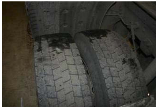
Figur 12: Dekkutrøstning drivhjul: Michelin X XDN 295/80R22,5 M+S 9 mm mønster.
