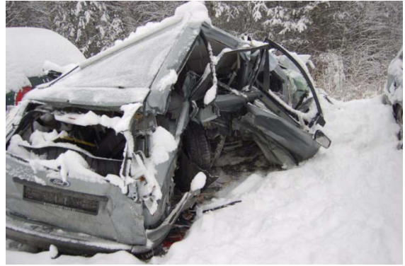
Figur 7: Massivt innpress på høyre side på Focus.
