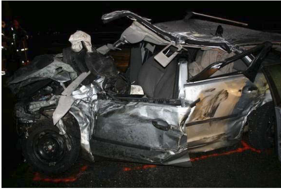
Figur 6: Store skader i front på Focus. Taket er klippet opp etter ulykken (foto: Statens vegvesen).
