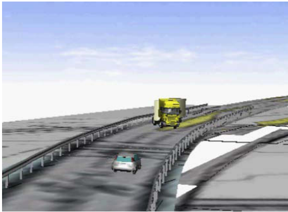
Figur 17: Illustrasjon fra simuleringene som viser hvordan trekkbilen kan ha skrenset mot venstre da den kom ut på brua.
