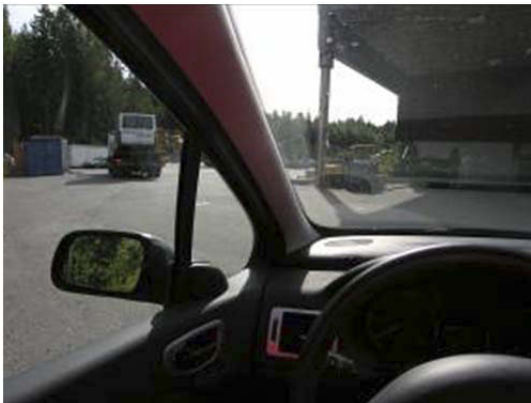
Figur 8: A-stolpen i tilsvarende personbil hindrer fri sikt. En dumper er plassert ca. 50 m unna i denne sonen på bildet.
