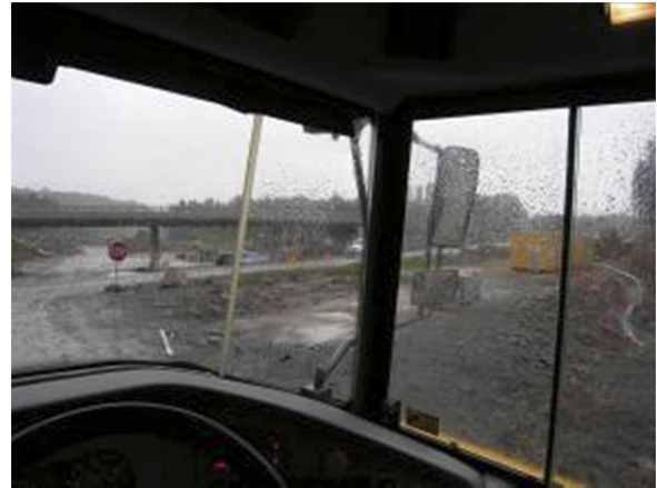
Figur 7: Utsyn fra førerhytta på en tilsvarende dumper ved befaringsulykkesstedet. En personbil er her delvis skjult bak A-stolpen.
