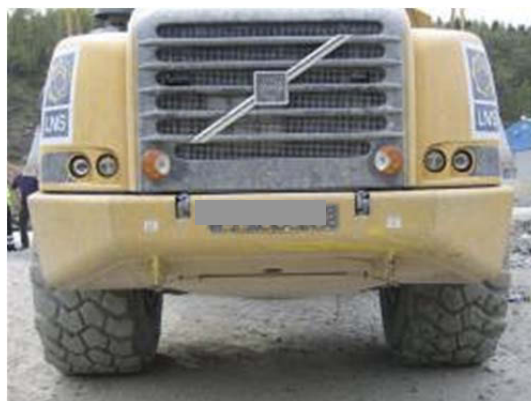
Figur 5: Kun merker i overflaten var synlige på dumperen etter ulykken (foto: Statens vegvesen).
