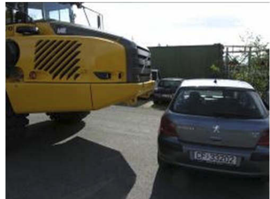
Figur 9: i denne posisjonen er personbilen ikke synlig for føreren av dumperen.
