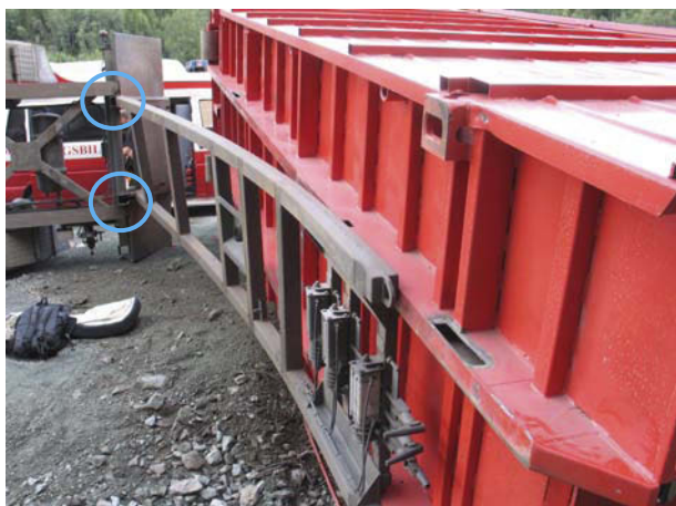
Figur 12: Viser skader på tilhengerens tippramme (blå ringer) og låsehåndtakenes posisjon. (Foto: Politiet)
