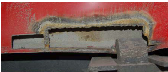
Figur 21: Viser bakre feste på høyre side og utskjæring i container.
