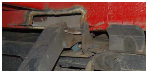
Figur 22: Viser fremre feste på høyre side, samt utskjæringer i krokcontainer.
