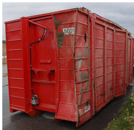
Figur 13: Viser skader på tilhengerens container.
