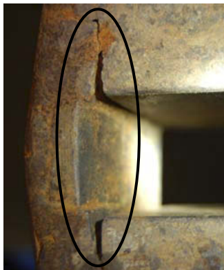
Figur 19: Viser slitasje ved monteringspunkt for høyre låseanordning.
