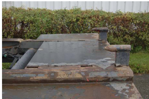
Figur 20: Viser låseanordninger og monteringspunkter.
