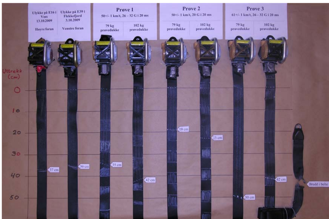
Figur 38: Viser bilde av bilbelter som har vært involvert i ulykker nr. 7 og ulykke nr. 8, samt belter som har vært benyttet ifm. kollisjonstester hos SP i Borås.
