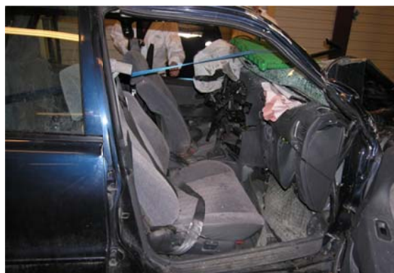
Figur 10: Begrenset overlevelsesrom på førerplass.
