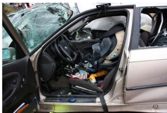
Figur 20: Skader i front og høyre side på BMW 325i (foto: politiet). Ingen overlevelsesrom på bilens høyre side, overlevelsesrom på førerplass.
