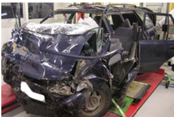
Figur 9: Skader i fronten på Mitsubishi Lancer. Overlevelsesrom på alle plasser i bilen foruten på førerplass.
