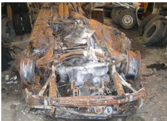
Figur 22: Mercedes E220 helt utbrent, ingen overlevelsesrom i bilen.
