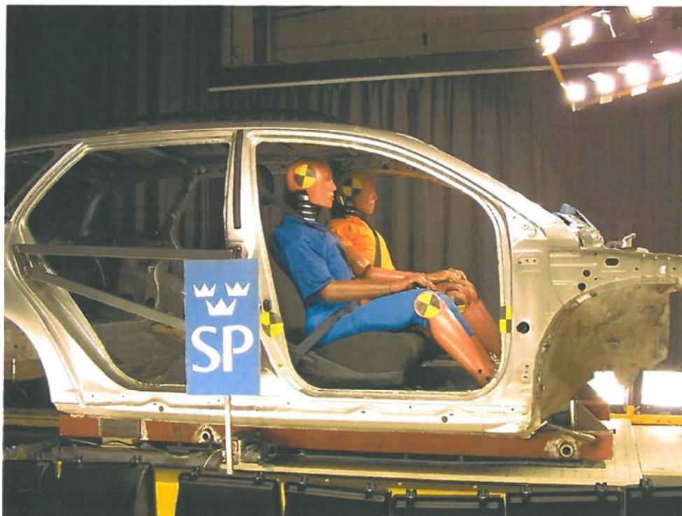
Figur 37: Karosseri med dukker før gjennomføring av tester.
