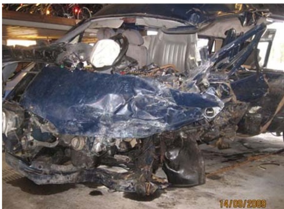
Figur 25: Skader i front på Ford Transit (foto: Statens vegvesen). Overlevelsesrom på alle plasser i bilen, begrenset overlevelsesrom på førerplass.
