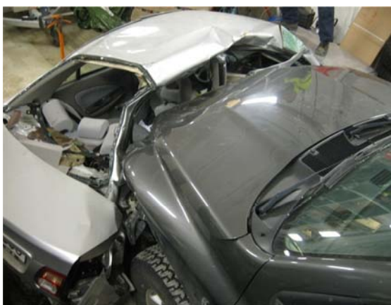
Figur 13: Rekonstruksjon som viser kjøretøyenes innbyrdes posisjoner i kollisjonsøyeblikket.
