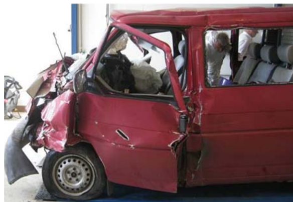
Figur 23: Skader i front på VW Caravelle. Overlevelsesrom på førerplass.
