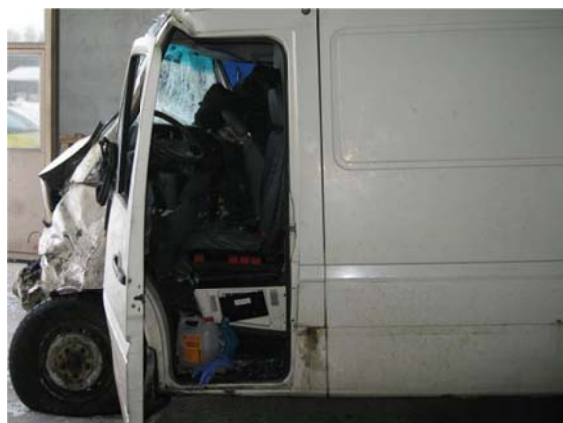
Figur 17: Skader i front på Mercedes Sprinter varebil. Overlevelsesrom på førerplass.
