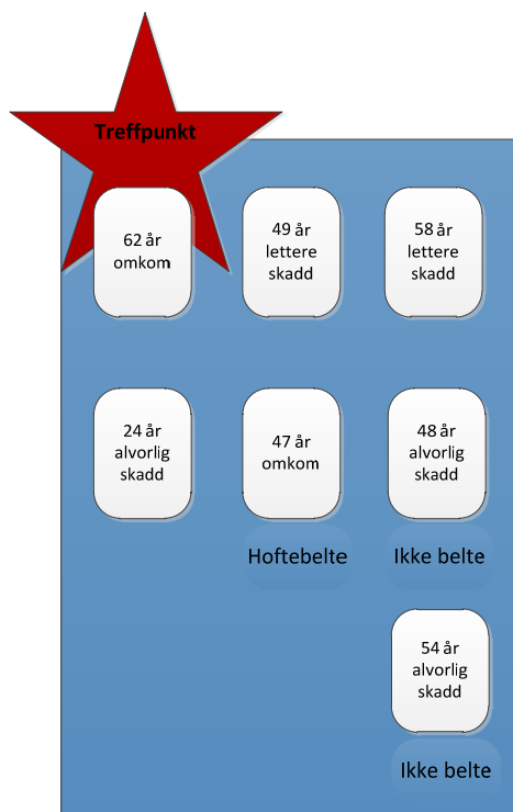
Figur 27: Passasjerenes plassering i Ford Transit, bilbeltebruk og skadegrad.
