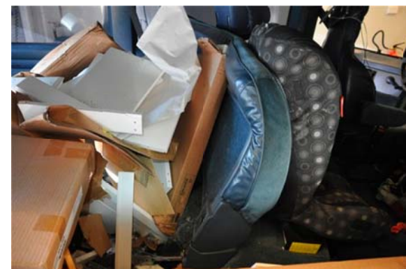
Figur 32: Lastforskyvning i seterygg for barnet i midten bak i Chevrolet Astro.
