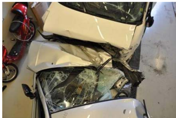
Figur 30: Rekonstruksjon som viser kjøretøyenes innbyrdes posisjoner i kollisjonsøyeblikket.
