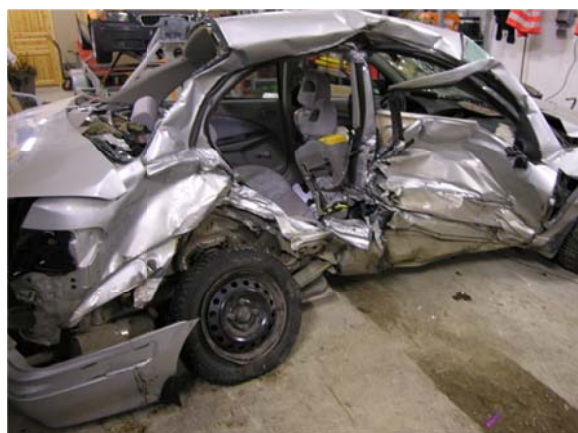
Figur 14: Store skader i høyre side på Nissan Almera. Overlevelsesrom på førerplass, ingen overlevelsesrom på passasjeretsetet foran og høyre side bak.
