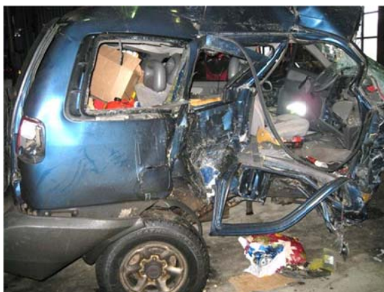
Figur 16: Skader i høyre side på Nissan Terrano. Ingen overlevelsesrom på passasjerselet foran, begrenset overlevelsesrom på førerplass.
