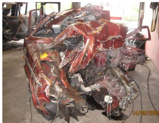
Figur 26: Totalskadet Volvo 240 (foto: Statens vegvesen). Ingen overlevelsesrom på førerplass.
