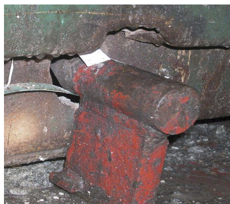
Figur 35: Slitasje/skade i forbindelse med containerens hull tilpasset bakre låseanordning på tilhenger (Foto: Statens vegvesen)
