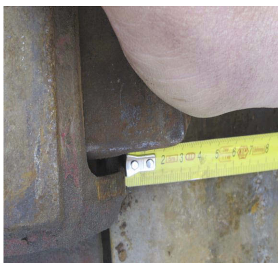
Figur 16: Viser mulighet for å trykke inn låsepal med håndmakt.
