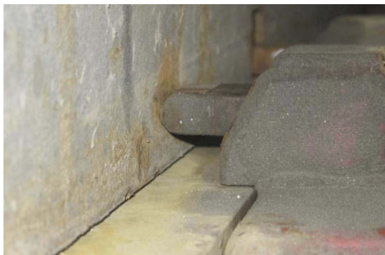
Figur 17: Ytterste låsepal treffer rammevange på høyre side (i kjøreretning). Bak skimtes låsepalenes inngrep i tiltenkt hull. Viser også frihetsgraden på høyre side (i kjøreretningen). Se i sammenheng med Figur 13.
