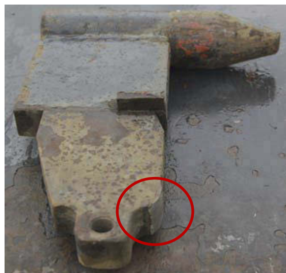
Figur 6: Høyre låseanordning med manglende tapp som tar vertikalbelastning.
