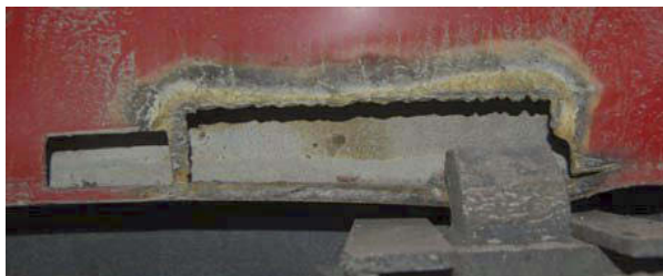
Figur 9: Bakre lås på lastebilens høyre side, samt utskjæring i container.
