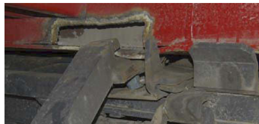
Figur 10: Framre lås på lastebilens høyre side, samt utskjæring i container.
