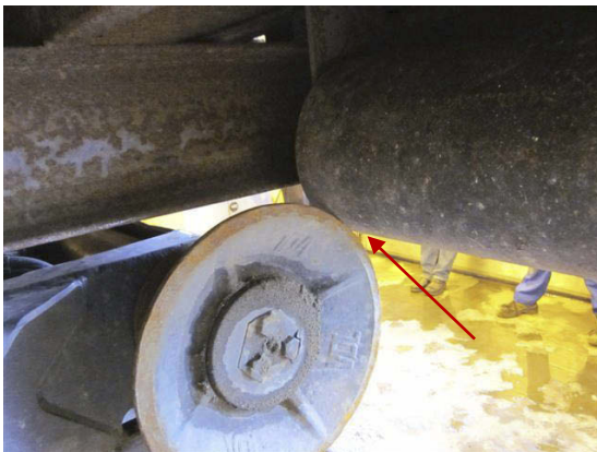
Figur 23: Viser den uheldige interaksjonen mellom bilens og containerens ruller når containeren er plassert i fremre posisjon (Foto: Statens vegvesen).
