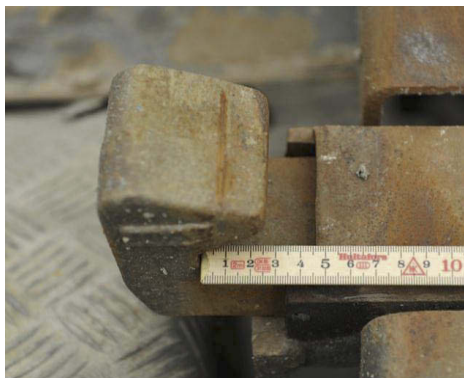
Figur 37: Inngrepet (2,6 cm) til en containerlås, samt slitasje på låsens overside som viser at en container kan ha stått på toppen av låseklaffen.
