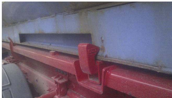
Figur 38: Viser en utvendig låseklaff som bommer på sitt tiltenkte hull i rammevange.
