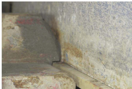
Figur 18: Ytterste låsepal på venstre side (i kjøreretning) trykkes helt inn mot rammevange.
