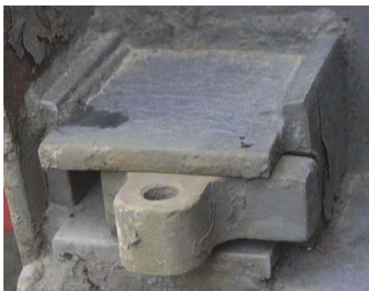
Figur 7: Monterte venstre låseanordning sett fra undersiden.
