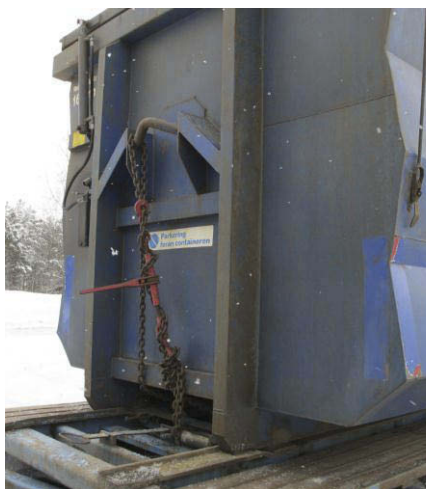
Figur 39: Bruk av kjetting for å sørge for ekstra sikring av krokcontaineren til tilhengeren.
