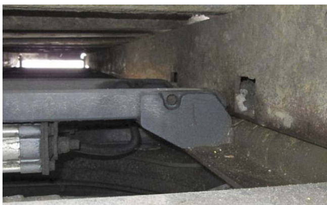
Figur 36: Innvendig lås på tilhenger som bommer på sitt tiltenkte hull i rammevange.
