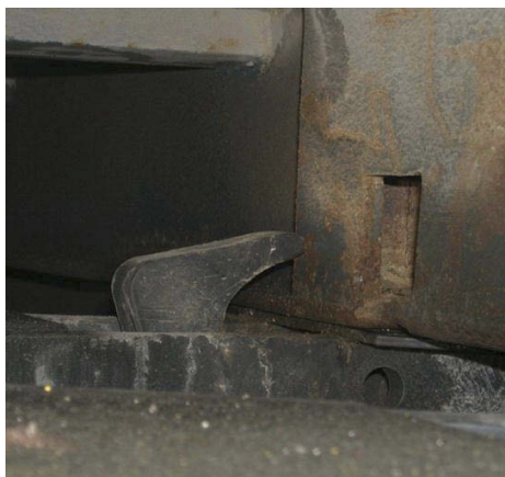
Figur 33: Innvendig låsmekanisme som ikke treffer sitt tiltenkte hull i krokcontaineren (Foto: Statens vegvesen)
