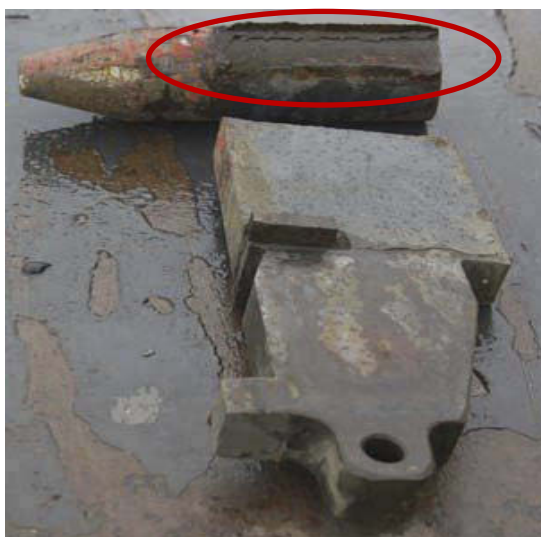
Figur 5: Venstre låseanordning med røket sveis mellom tapp og plate.
