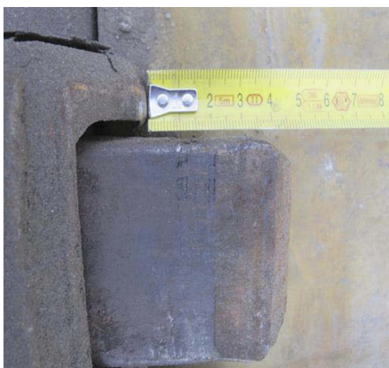
Figur 15: Viser maksimalt utstikk til en av låsepalene på tilhengeren.
