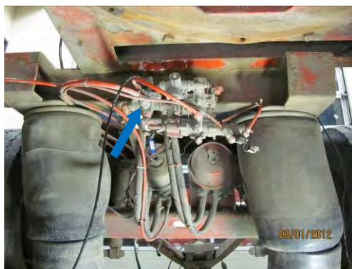
Figur 11: Viser hvor ABS modulator (blå pil), lastavhengig ventil og andre ventiler til fremre aksel er montert på tilhengeren. Foto: SHT
