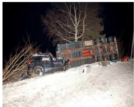
Figur 8: Viser sluttposisjonen og noe av skadene på personbilen og tilhengeren. Foto: Politiet
