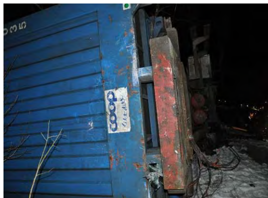
Figur 4: Tilhenger med container. Viser merker den fikk ved kollisjonen med personbilen. Foto: Statens vegvesen
