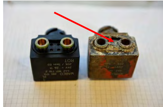
Figur 13: Viser en ny magnetventil og den som er vist i figur 12. Påvist salt partikler, se pil. Foto: SHT
