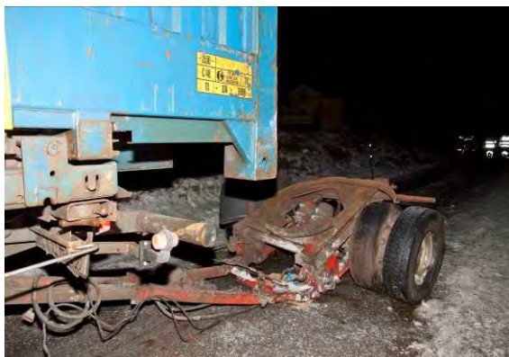
Figur 3: Tilhengerdraget er deformert, og viser de deler av draget som hadde merker fra berørte med vegbanen. Foto: Politiet
