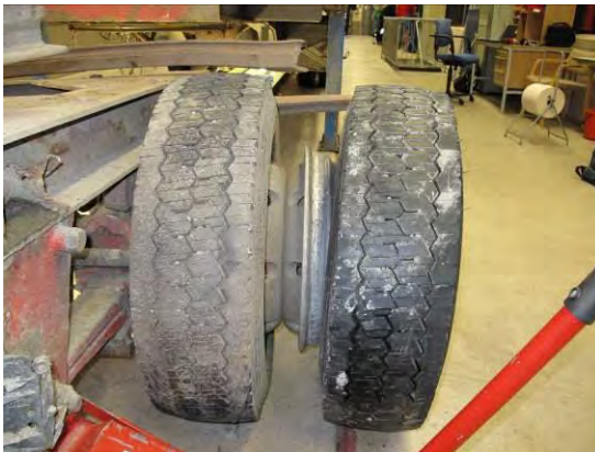
Figur 14: Bildet viser dekkutrustningen på venstre side fremre aksel på henger. Foto: SHT
