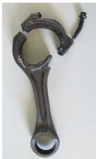
Figur 8: Veivstang, lageroverfall og løs bolt. Foto: SHT
