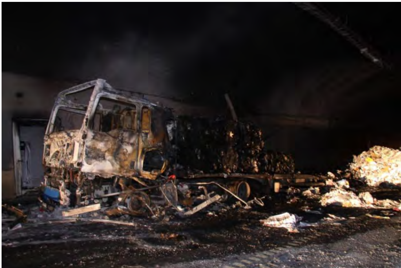
Figur 2-2 Restene av vogntogets last. Legg merke til hvit papirmasse til høyre i bildet. Foto: Politiet.
