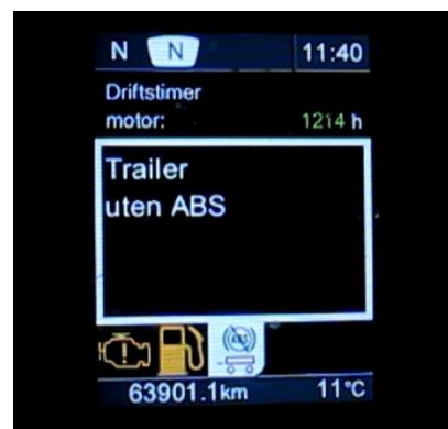
Figur 9: Informasjon på display som indikerer at semitraileren ikke har ABS funksjon. Foto: SHT
