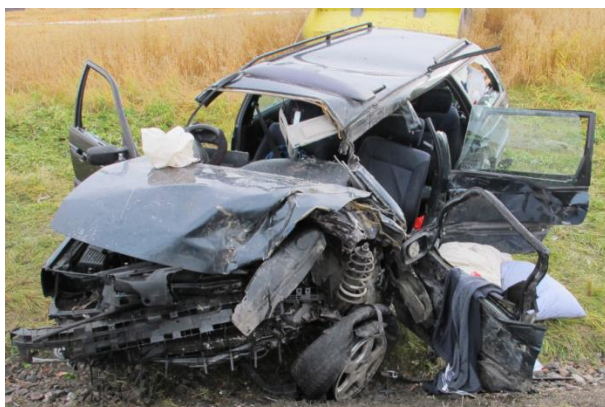
Figur 2: Skader i fronten og på venstre side av personbilen etter frigjøring av den fastklemte. Foto: SHT
