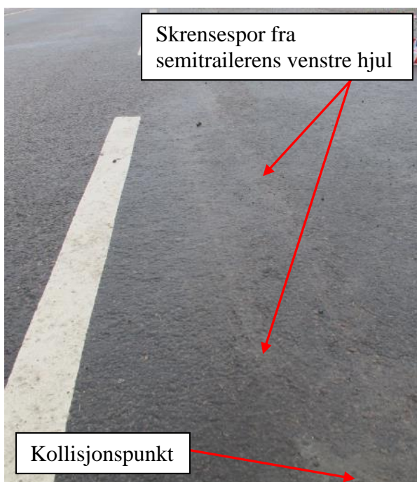
Figur 7: Avsatt brems-/skrensespor fra semitrailerens venstre hjul på utsiden av kantlinjen umiddelbart før kollisjonspunktet med personbilen (Bildet er tatt i personbilens kjøreretning). Foto/ill.: SHT
