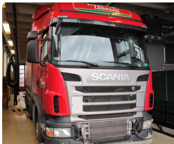
Figur 5: Skader i frontrute og nedre del av fronten. Foto: SHT
