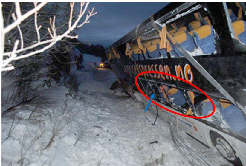
Figur 4: Bussen ble påført skader på høyre side, sirkelen viser de vinduene som ble knust i velten. Skiltmasten skadet en seterygg, se blå pil. Foto: Statens vegvesen
