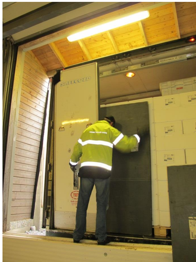
Figur 9: Ferdiglastet tilnærmet lik semitrailer med avstempling bakover med plater. Foto: SHT
