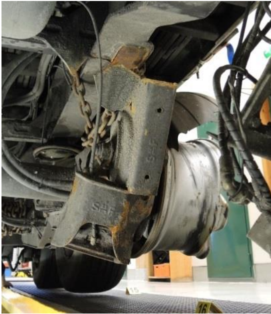
Figur 6: Venstre hjuloppheng på fremre aksel avrevet. Foto: SHT
