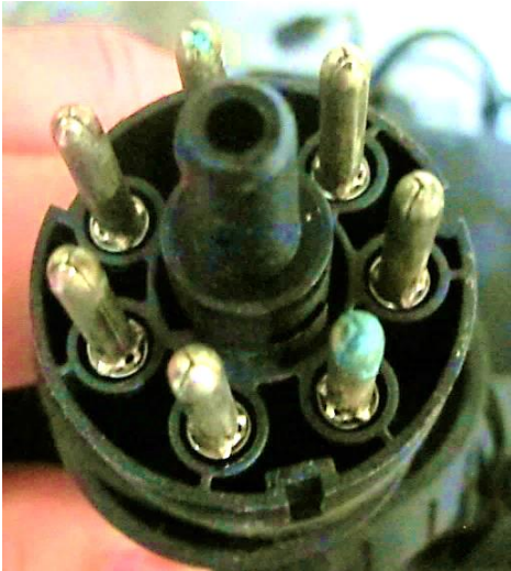
Figur 11: 7-PIN ABS-kontakt til semitrailer. Foto: SHT
