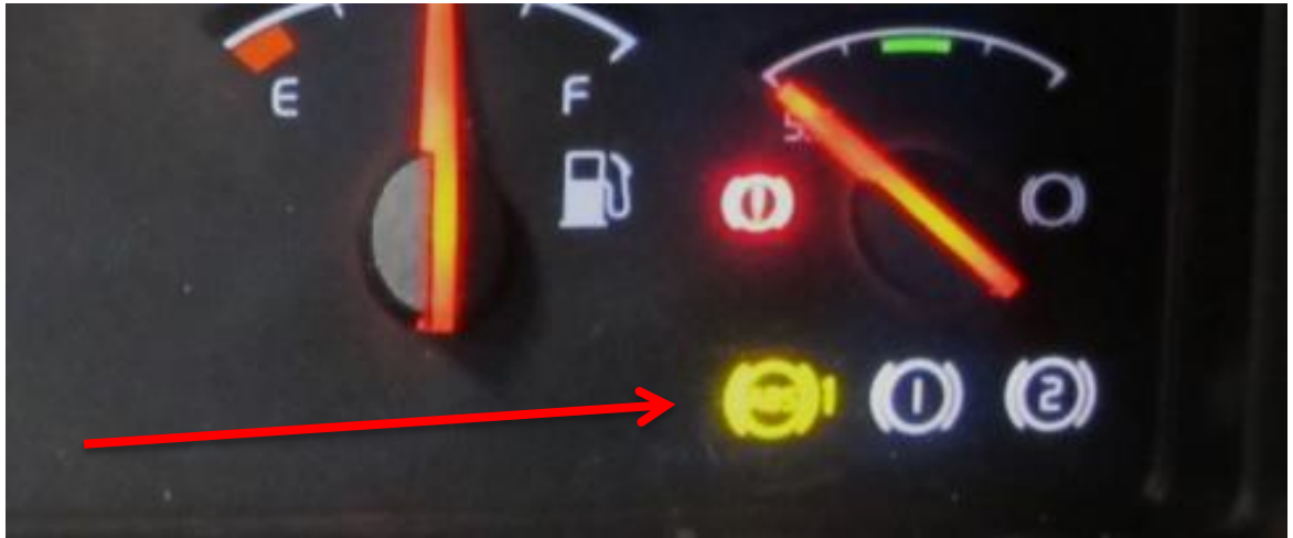
Figur 13: Førerdisplay, uten ABS strømforsyning sikring til trailer. Gult varsel vil si at det er tilkoblet en tilhenger med ABS-feil. (Pilen viser hvilken lampe som lyste under kjøring.) Foto: SHT
