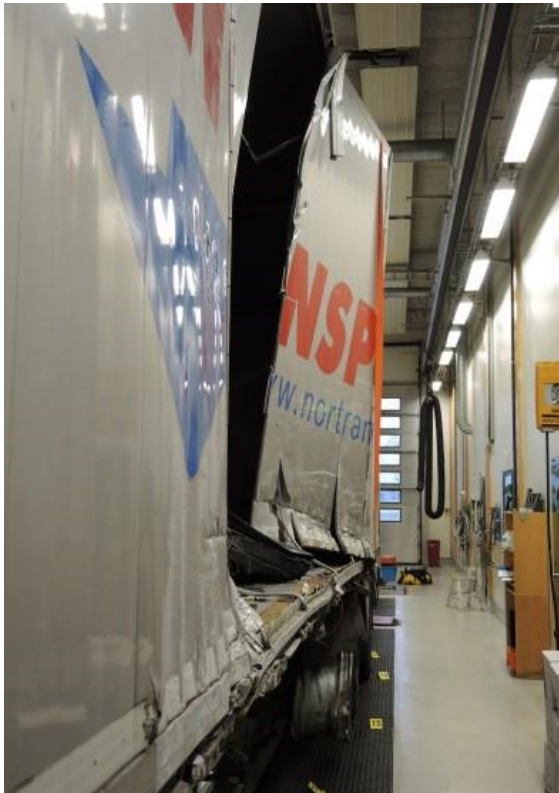
Figur 4: Skader venstre side på semitrailer. Foto: SHT
