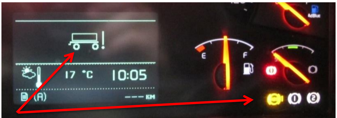
Figur 14: Førerdisplayet med ABS sikring til trailer montert. Feil i EBS kom da opp i førerdisplayet. (Pilene viser hvilke lamper som ville ha lyst med sikring i.) Foto: SHT
