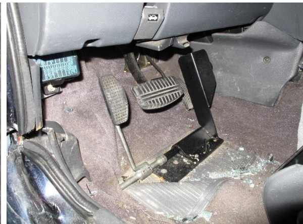
Figur 13: Illustrasjon på hvordan pedallett var montert i bilen. Foto: SHT
