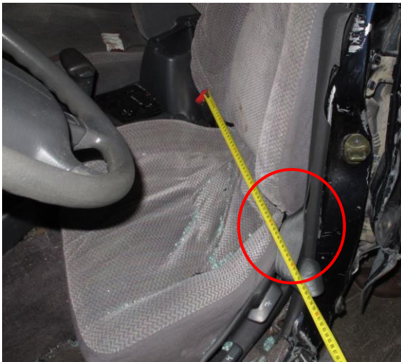
Figur 3: Sirkelen viser at bilbeltet ligger klemt mellom forsetet og B-stolpen. Noe som indikerer at bilbelte ikke hadde vært i bruk. Foto: SHT
