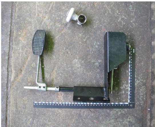
Figur 12: Pedallett og rattkule som var påmontert i bilen. Foto: SHT
