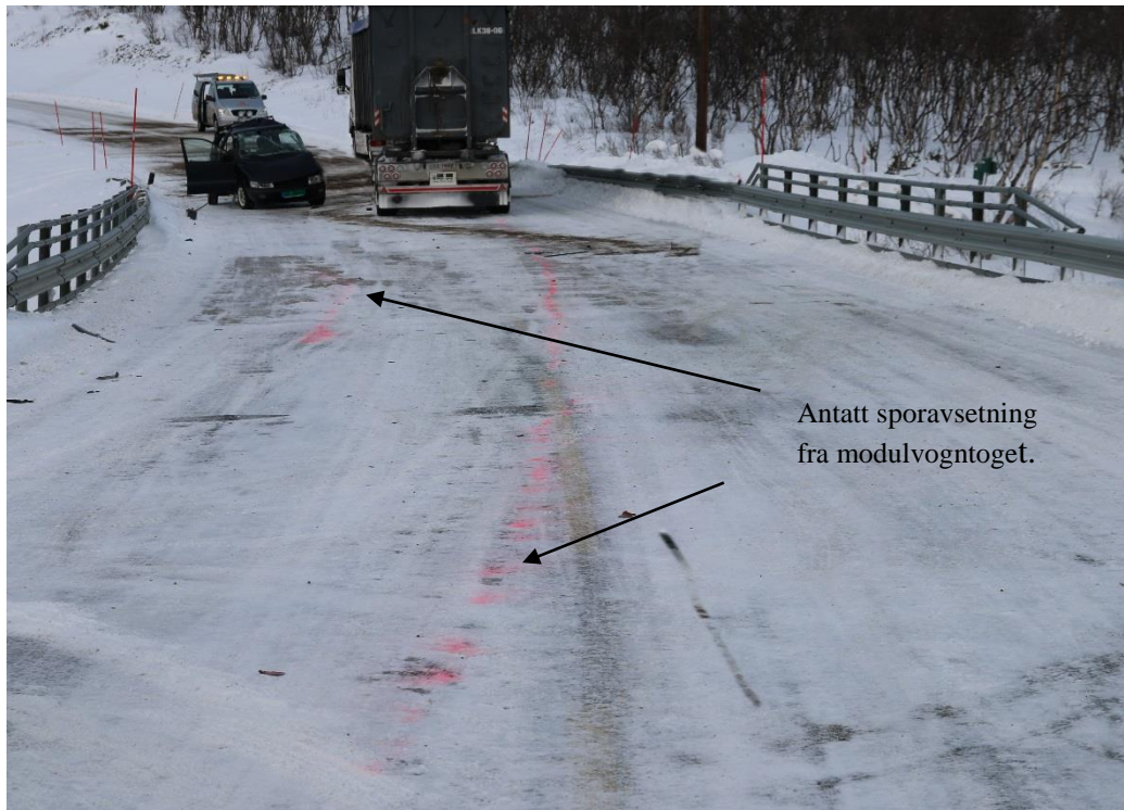
Figur 11: Oversikt over ulykkesstedet som viser kjøretøyenes sluttposisjon. Antatt sporavsetningen fra modulvogntoget. Foto: Politiet
