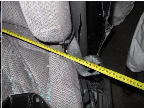
Figur 7: Nærbildet av førersetet viser at det ble presset inn med ca. 6 cm. Foto: SHT
