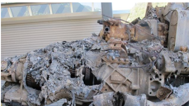
Figur 8: Skadene på bussens girkasse som følge av brannen. Foto: SHT
