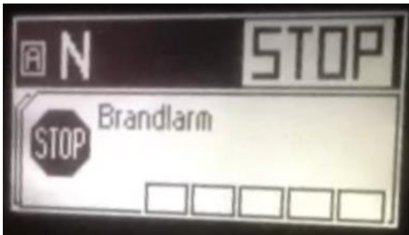
Figur 11: Dashborddisplay ved utløst brannslokkeanlegg i tilsvarende buss. Foto: Stenstorp Buss
