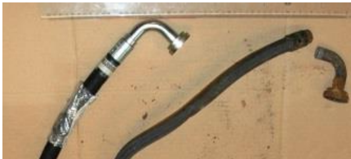
Figur 17: Ny hydraulikkslange som referanse til venstre. Utbrent hydraulikkslange med brudd til høyre. Foto: FOLAT
