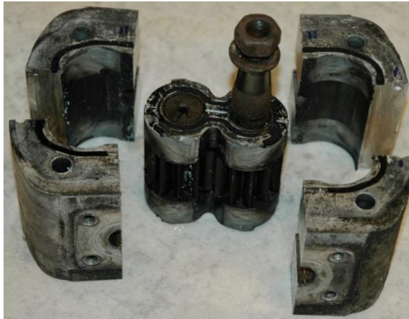
Figur 16: Viftemotor ble undersøkt med røntgen og delt i etterkant. Foto: FOLAT
