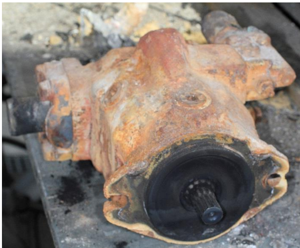
Figur 20: Frakoblet hydraulikkpumpe. Foto: SHT
