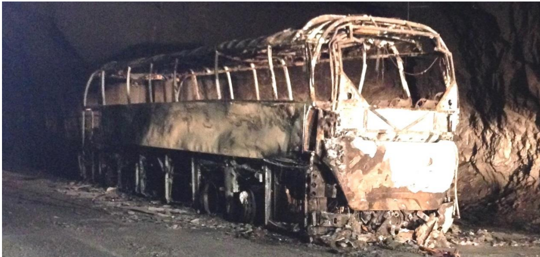
Figur 5: Utbrent buss i tunnel. Foto: SHT
