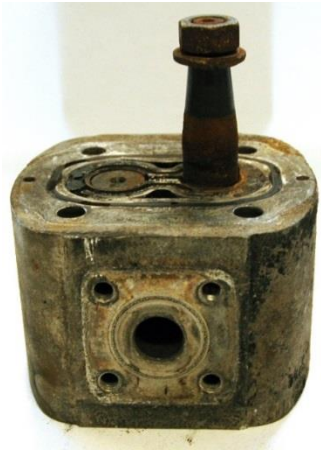
Figur 15: Viftemotor til kjølesystemet. Foto: FOLAT
