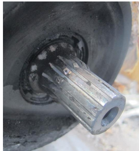
Figur 21: Nedslitte griperiller (splines) på drivaksel. Foto: SHT
