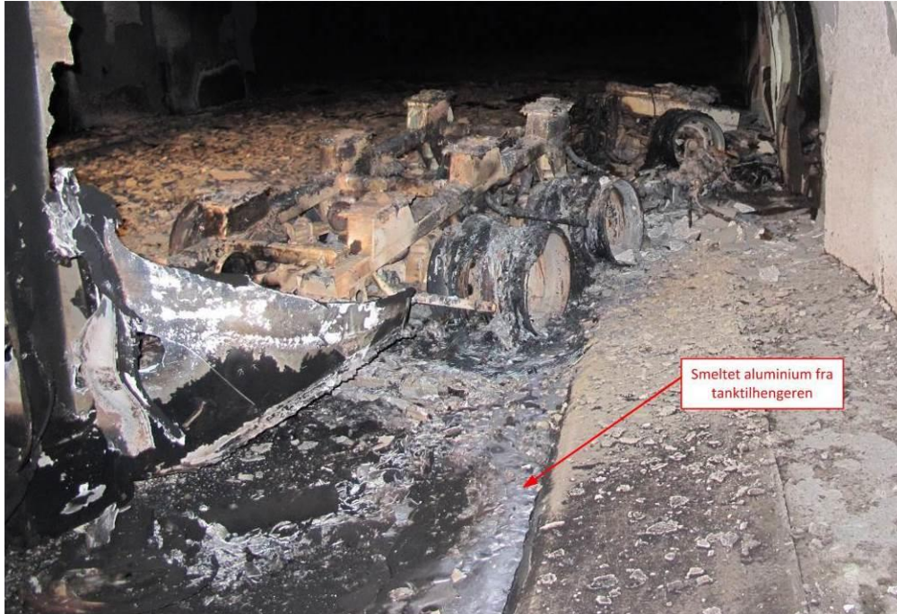
Figur 6: Restene av tanktilhengeren slik den ble stående i tunnelen. Foto: SHT
