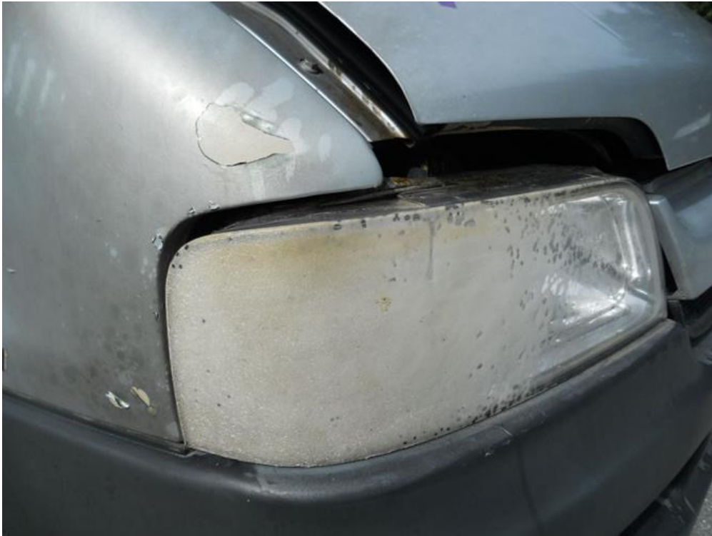
Figur 23. Nærbilde av panseret på campingbilen som kom kjørende bak tankbilen og som stoppet bak hengeren. Bildet viser at panseret har løftet seg, sannsynligvis som følge av en trykkendring i motorrommet. Foto: Gjensidige
