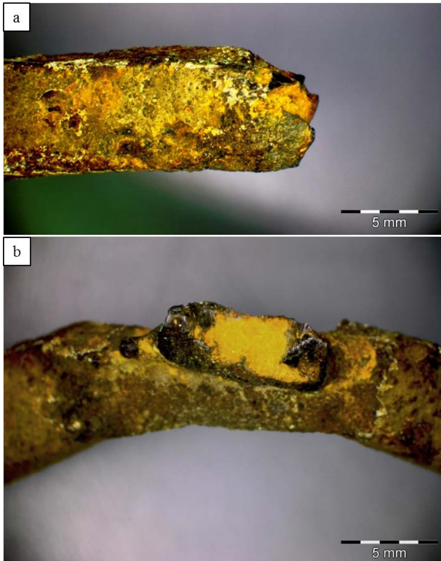
Figur 17 Bilde av a: Brudd i nettingtråd og b: Brudd i sveisepunkt.
