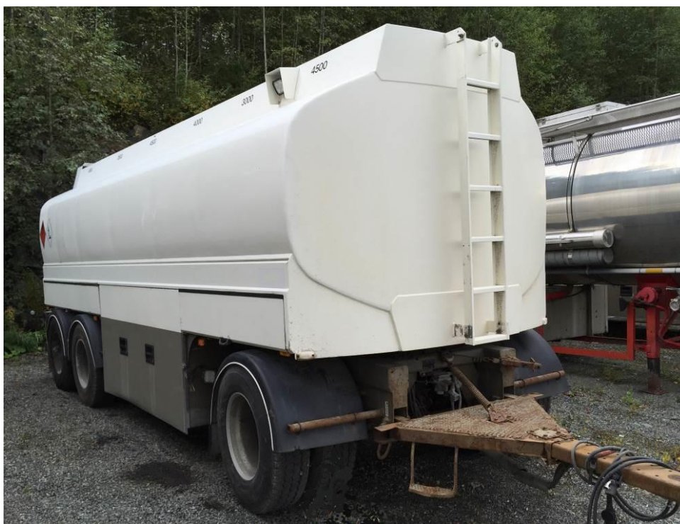
Figur 11: Tanktilhenger av tilsvarende fabrikat og type som den som brant i Skatestraumtunnelen. Foto: SHT
