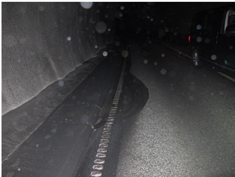
Figur 20 Vid brunn nr 3 finns en avvikelse på hur bensenen har runnit ner längs vägbanan. Den buktar ut och det ser ut som bensen har flödat ut ifrån brunnen.
