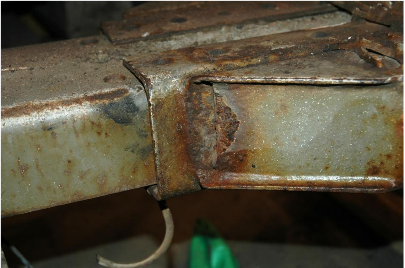
Figur 3 Bilde som viser innsveising av profil til innfestet av draget med åpning som gir fuktinntrenging på innsiden av profil.
