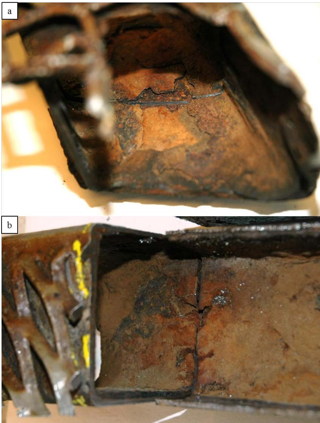
Figur 6 a: Bilde av gjennomrusting H-side, b: Bilde av gjennomrusting V-side.
