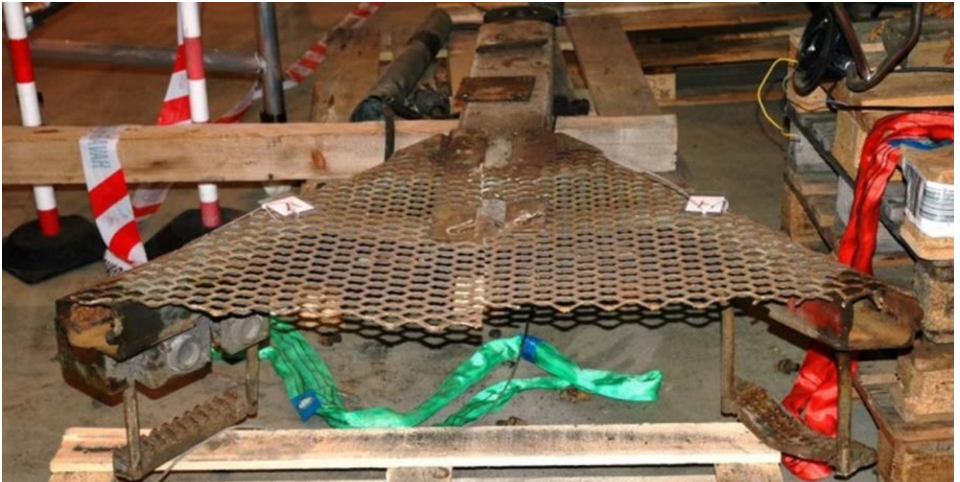
Figur 1 Oversiktsbilde av drag med bruddskader.
