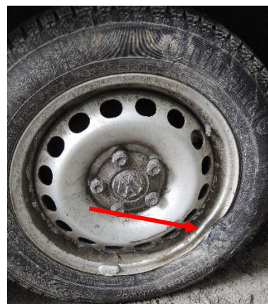
Figur 7: Deformasjon på bakre høyre felg. Foto: SHT
