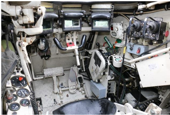
Figur 14: Vognførerplass med ratt, to pedaler for gass og brems, hevbart sete og girskifter. Foto: Politiet
