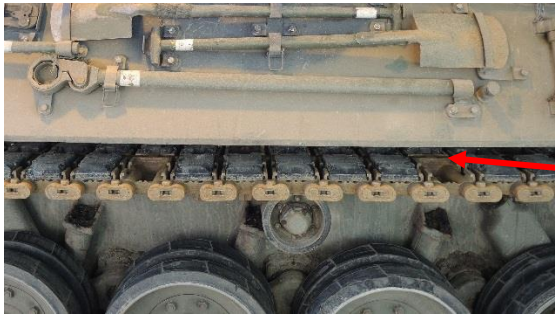
Figur 17: Gummibelte med gummisko, hver sjette sko ledig for snøsko. Foto: SHT
