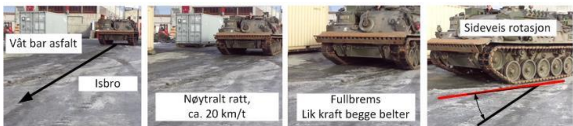
Figur 16: Bildesekvens fra video av bremsetest med splitfriksjon, bergepanser kjørende mot kamera. Foto: Ritek
