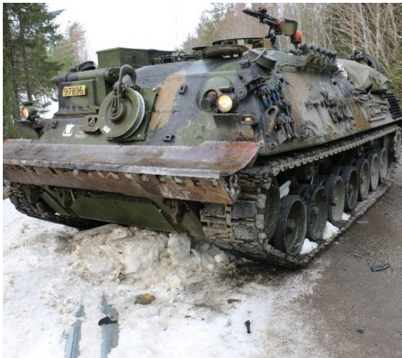
Figur 8: Overfladiske skader på bergespanser. Foto: Politiet
