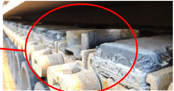
Figur 18: Snøsko innsatt, bygger ca. 1 cm over gummisko. Foto: SHT
