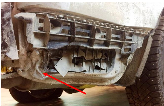
Figur 6: Deformasjon på nedre del av høyre bakpart. Foto: SHT
