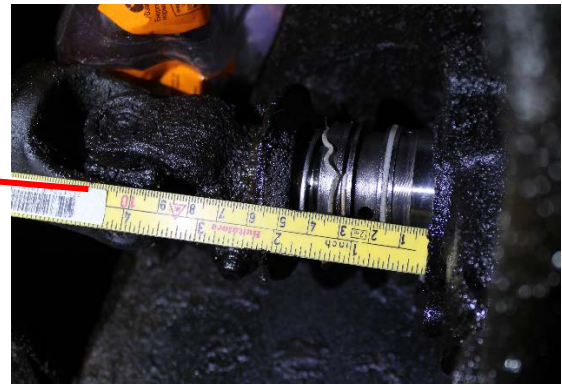
Figur 15: Bruddet i styresnekka og oljesøl. Avstanden akselen i styresnekka ble presset ut var målbar. Foto: Statens vegvesen
