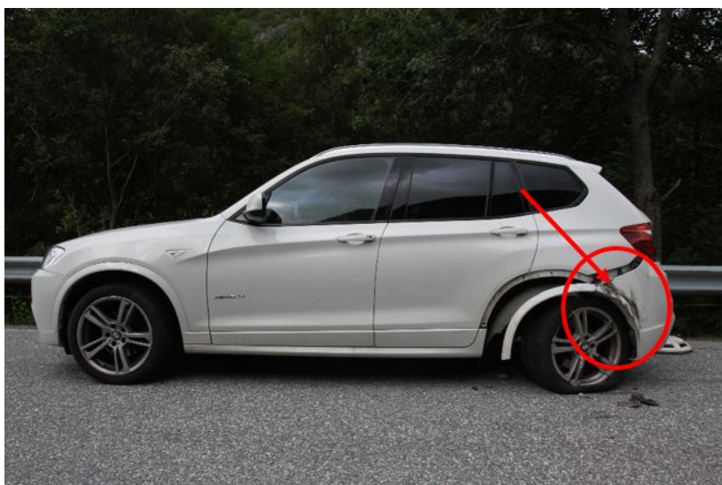
Figur 7: Rød sirkel markerer skader personbilen ble påført i sammenstøtet med bussen, blant annet gummispør fra bussens venstre forhjul. Foto: Politiet
