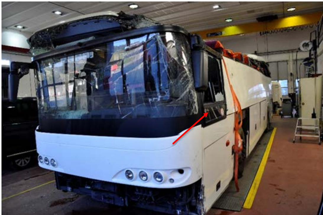
Figur 6: Skader bussen ble påført i sammenstøtet og i den påfølgende velten, hvor taket ble forskjøvet mot høyre. Foto: SHT
