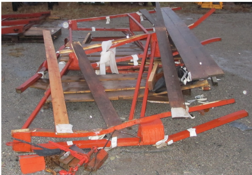
Figur 5: Skader på A-krakken som ble brukt i forbindelse med transporten. Foto: SHT
