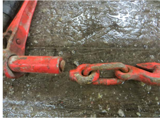
Figur 14: Skader på kjettingstrammer. Foto: Statens vegvesen
