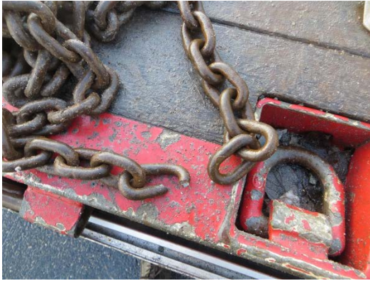
Figur 13: Skader på kjetting. Foto: Statens vegvesen
