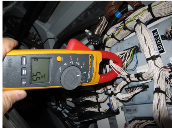
Figur 18: Skiltlyskretsen med 5,5 A, over forbruket ved brann i skiltlyset. Foto: SHT
