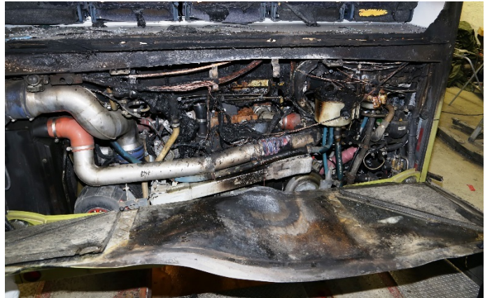
Figur 7: Fra brann 17 desember 2016. Smeltet plast i motorrom, og isolasjon brent i v-form på innsiden av bakluke. Foto: Politiet
