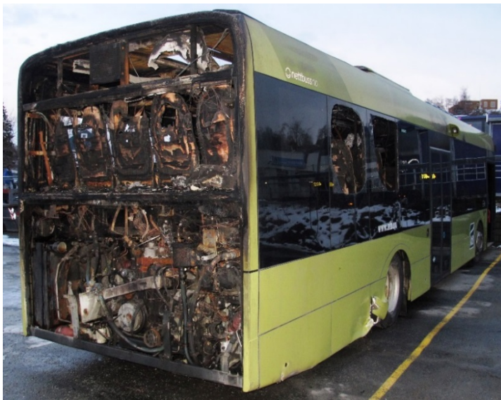
Figur 8: Brann 13. november 2016. Skader motorrom. Foto: SHT
