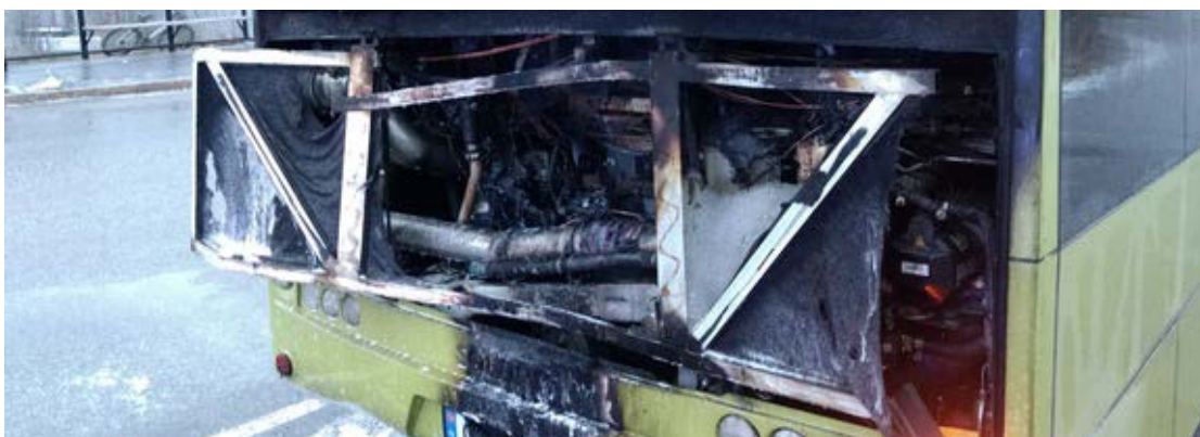
Figur 2: Nærbilde brannskade bak. Foto: Politiet
