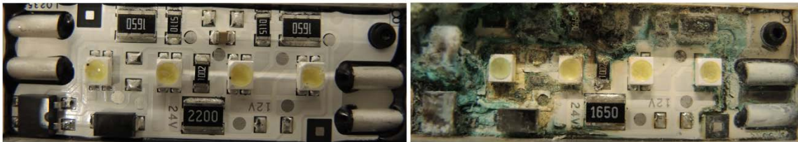
Figur 19: Innmaten til nytt LED-lys til venstre, og til høyre ett defekt og korrodert. Foto: SHT
