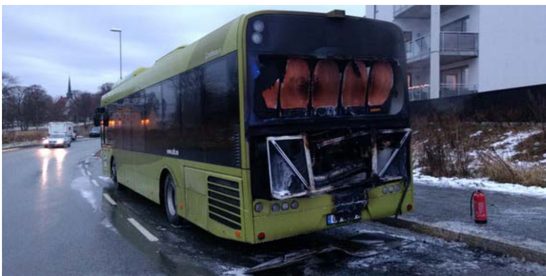
Figur 1: Brannskader bakpart, bakdeksel til motorrom ligger på bakken bak bussen og slokkeapparat var tømt. Foto: Politiet
