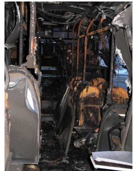
Figur 9: Brann 13. november 2016. Brannskader interiør, sett bakover i bussen. Foto: SHT
