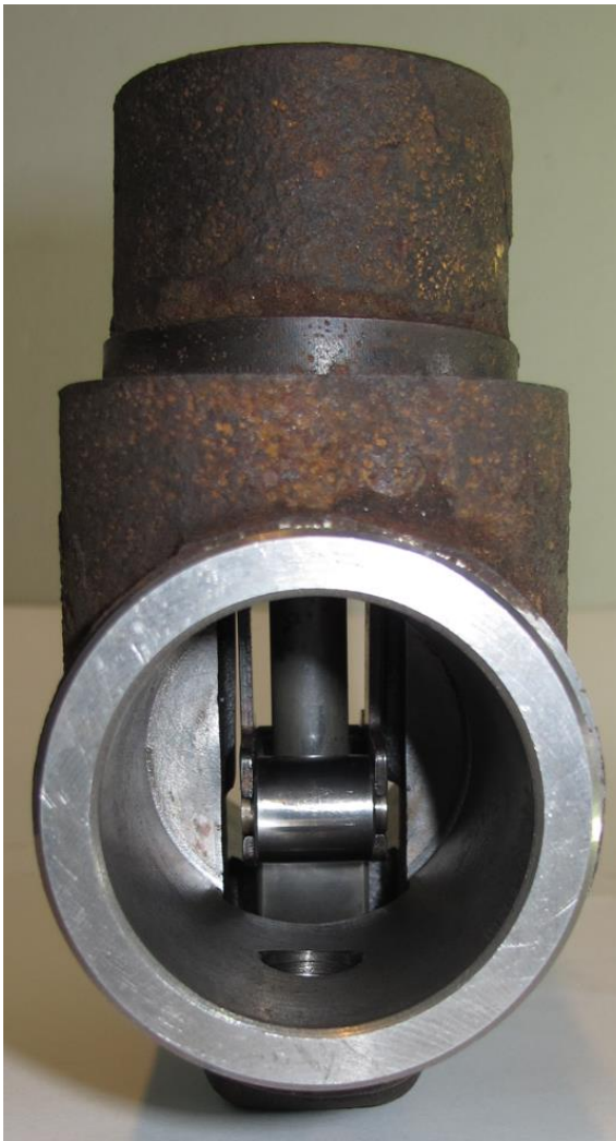
Figur 10: Rulleholder glippet over. Støtstang med kilen i bunn på huset og rulleholder ved overgang kile og støtstang. Foto: SHT
