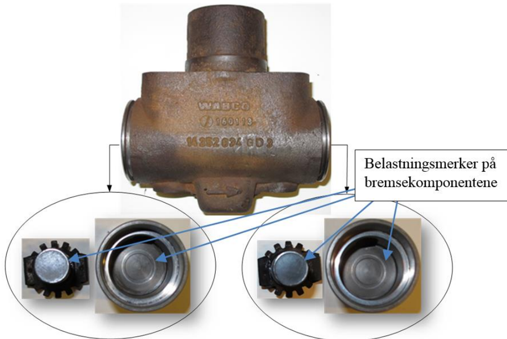
Figur 7: Fysiske merker etter kontakt mellom selvjusteringsskruen og bunnen på stemplene i hjulsylindrene på venstre side, se blå piler. Foto: SHT
