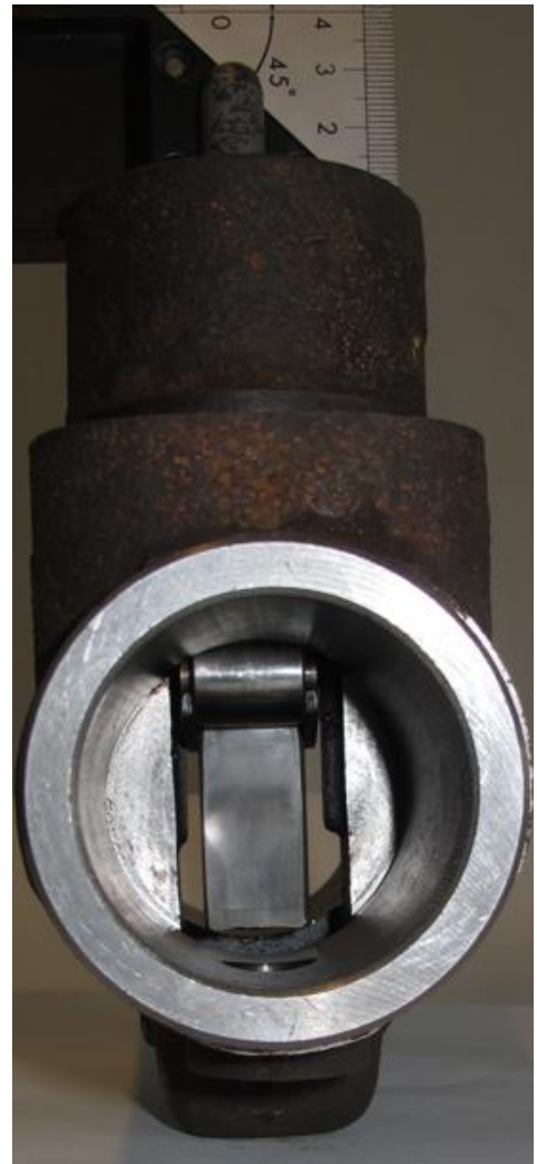
Figur 11: Antatt posisjon av støtstang og rulleholder slik figur 5 og figur 6 viser. Foto: SHT
