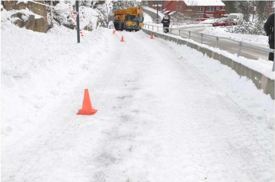
Figur 3: Sporavsetning og sluttposisjonen til mobilkranen. Første kjeglen viser endring i sporavsetning fra høyre framhjul. Foto: Politiet
