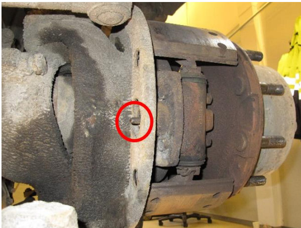
Figur 5: Støtstang sitter fast innvendig i hjulsylinder venstre side. Hjulsylinder og bremsesko venstre side. Foto: SHT
