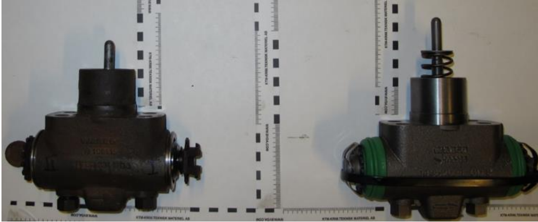
Figur 9: I bilde på venstre side er kilesystem montert tilnærmet slik det var ved demontering, se figur 5 og figur 6. På høyre side i bilde er posisjonen på kilesystemet slik det normalt skal være. Foto: SHT
