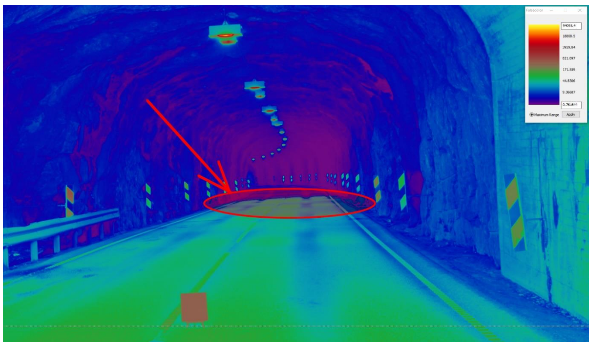
Figur 3. Bildet viser Innkjøringssone av Raunekleivtunnelen i falske farger. De falske fargene er tildelt piksler med bestemte luminansnivåer. Luminansskalaen er i høyre øverste hjørne av bildet. Den røde ovale formen markerer stedet hvor belysningen reduseres drastisk.
