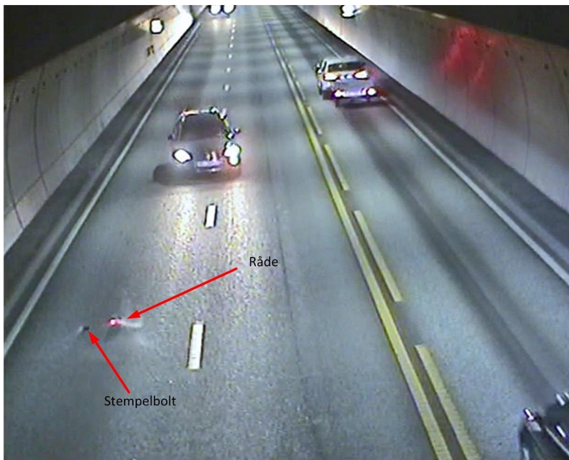
Figur 18: En stempelbolt og en rødgloedende råde ble liggende i veibanen i tunnellopet etter at motorhavariet inntraff. Foto: Utklipp fra videoovervåkning i tunnelen – Statens vegvesen
