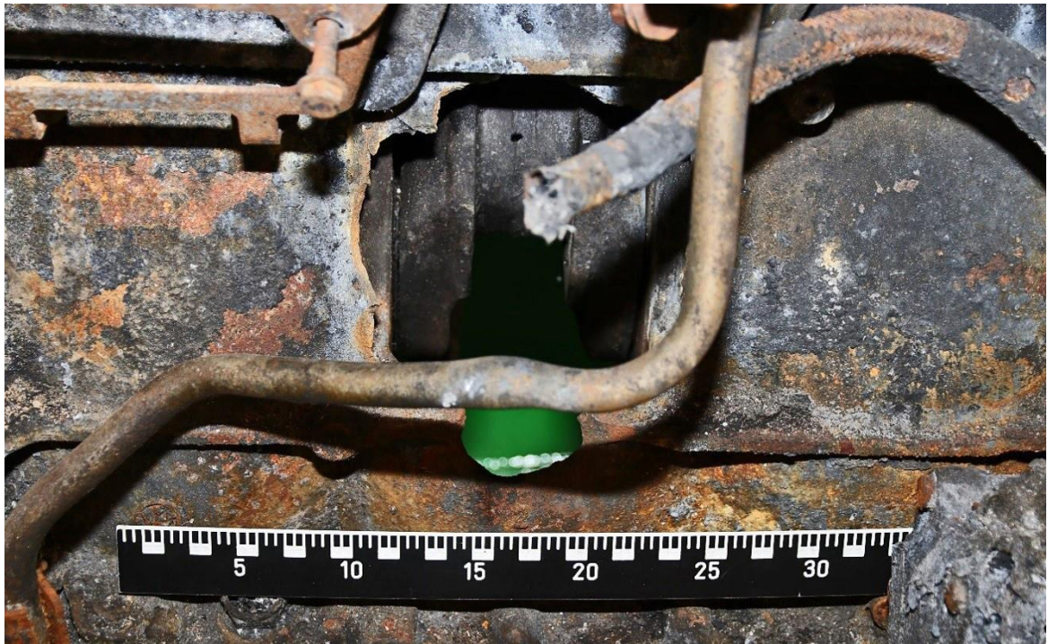
Figur 19: Hull i motorblokkens nedre venstre side. Drivstoffrøret montert på utsiden av motorblokken var revet av. Foto: Politiet
