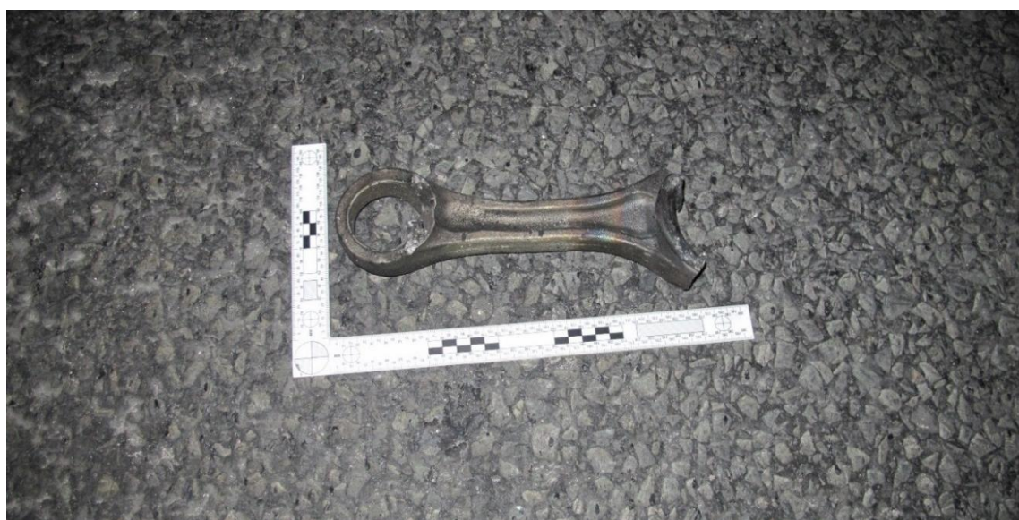
Figur 17: En av motorens råder, lokalisert 67,6 meter bak det utbrente vogntoget i veibanen. Foto: Politiet
