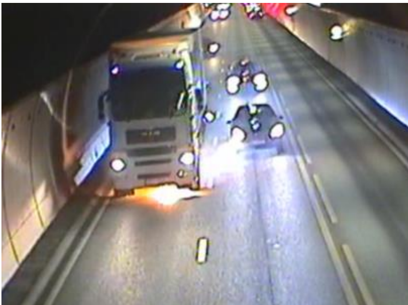
Figur 2: Utløsende hendelse med påbegynnende brann under lastebilen. Foto: Utklipp fra videoovervåkning i tunnelen – Statens vegvesen
