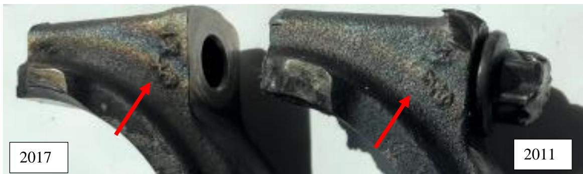
Figur 41: Innfestning til overfallslager fra 2017 (venstre) og 2011 (høyre) med fargeendringer som følge av varmepåvirkning. Foto: SHT
