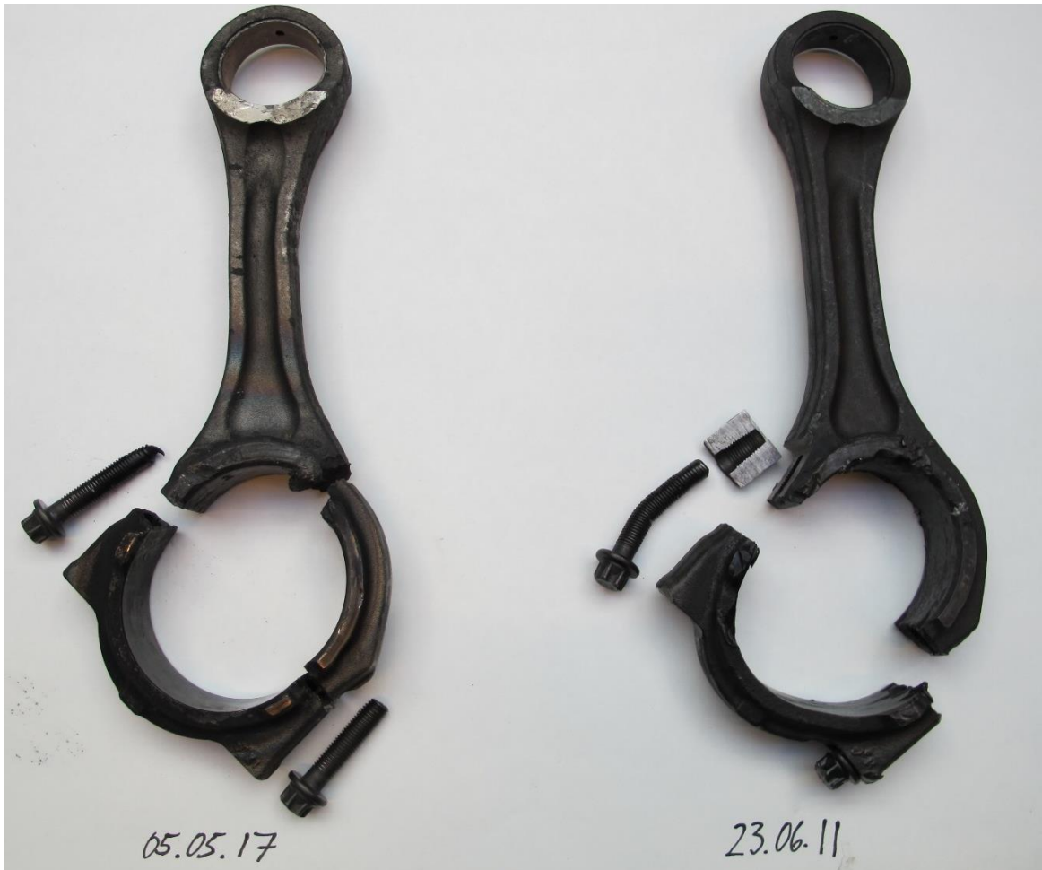
Figur 40: Rådene fra brannene i 2017 (venstre) og 2011 (høyre). Foto: SHT
