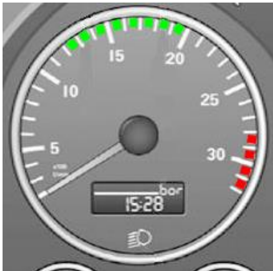
Figur 29: Turteller som viser forskjellige turtallsområder i rpm. Kilde: MAN. Illustrasjon: SHT
