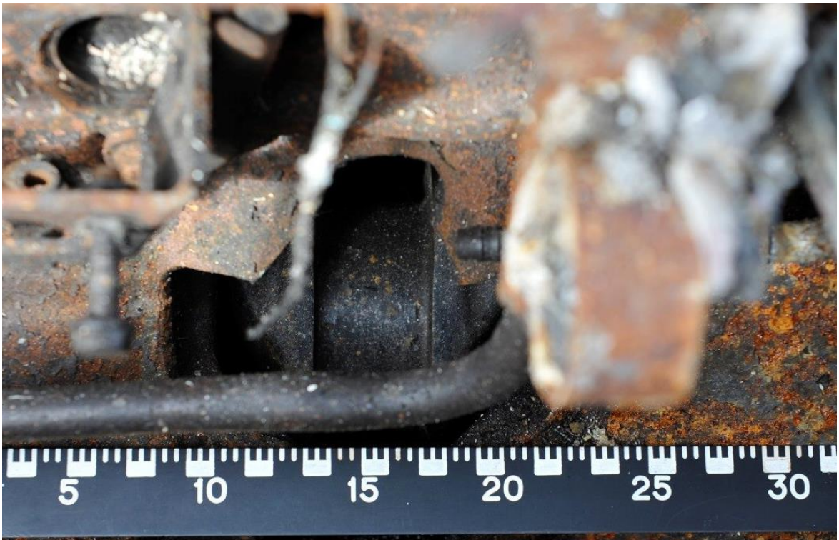
Figur 39: Rådelager til sylinder nr. 4 sett igjennom hullet i motorblokken til trekkbilen som brant i 2011. Foto: SHT
