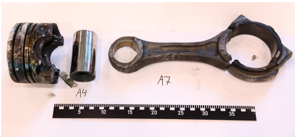
Figur 21: Deler fra sylinder nr. 4, med blant annet stempel, stempelbolt og råde. Foto: Politiet
