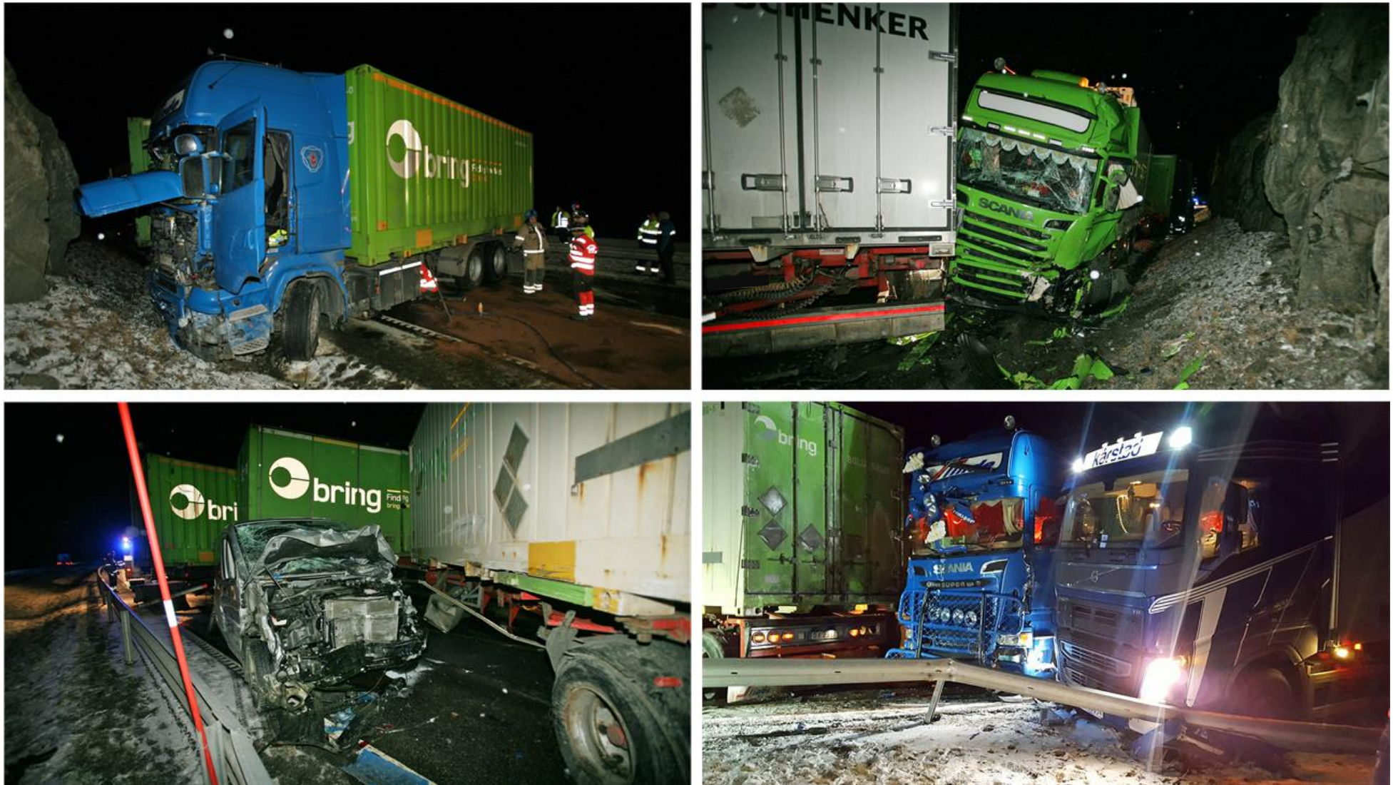
Figur 11: Skader på de fem kjøretøyene som var involvert i kjedekollisjonen. Bildene øverst til venstre og høyre viser henholdsvis det første og andre vogntoget. Bildet nederst til venstre viser varebilen, og bildet nederst til høyre viser det tredje vogntoget samt lastebilen. Foto: Odd Helge Brugrand/Kai Roger Gjelsvik
