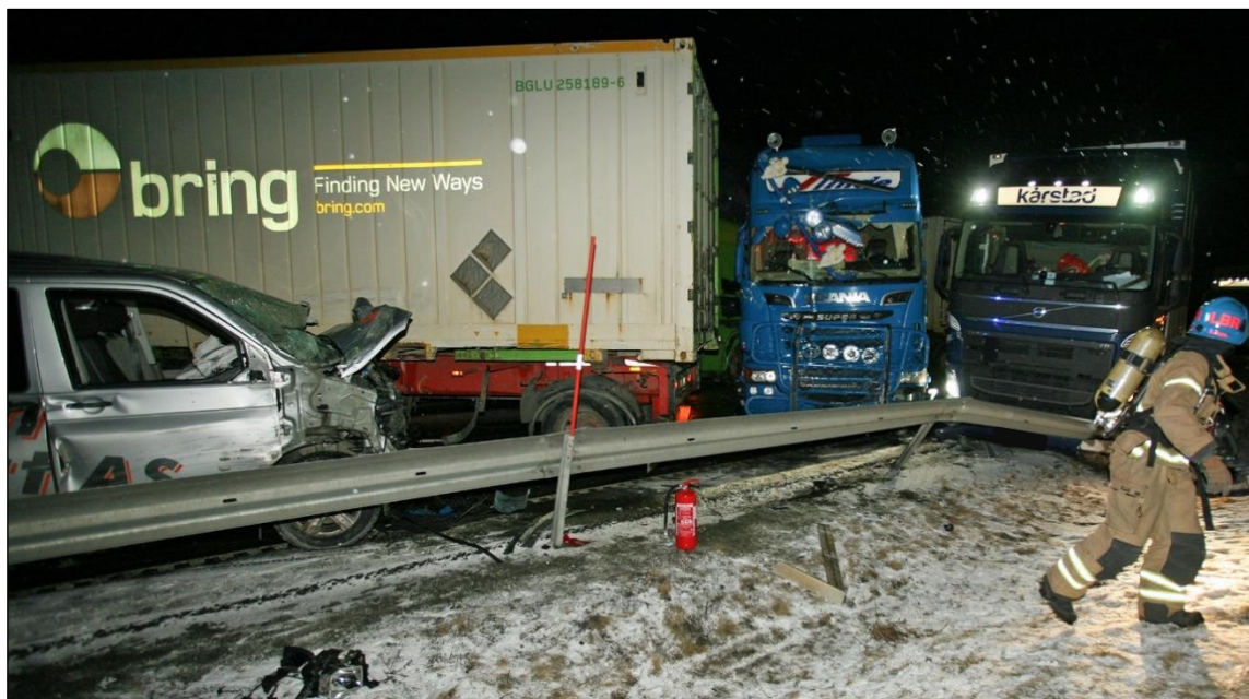
Figur 9: Varebilen ble totalskadet i ulykken, men hadde tilgjengelig overlevelsesrom etter sammenstøt med flere tunge kjøretøy. Foto: Odd Helge Brugrand
