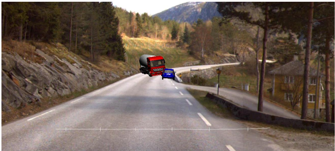
Figur 15: Simulerte posisjonar i kollisjonsaugneblinken. Illustrasjon: Rekon DA
