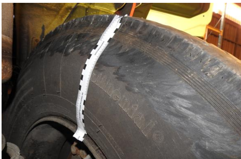
Figur 5: Merke på innsida av dekket på høyre side på framhjul. Foto: SHT
