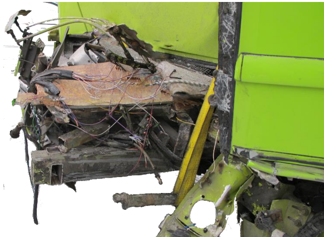
Figur 6: Avkappet tverrbjelke på venstre side, sett fra siden. Foto: SHT
