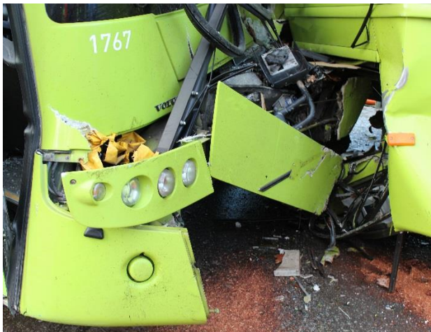
Figur 9: Overlapp og inntrenging mellom bussene på ulykkesstedet. Foto: Statens Vegvesen
