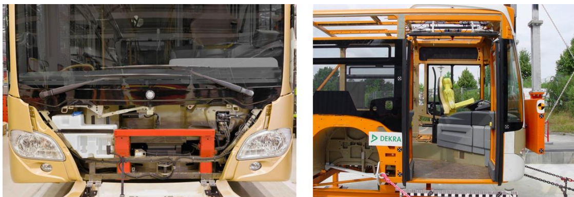
Figur 31: Forsterkning i front på Mercedes-Benz Citario, for å imøtekomme krav i ECE-R-29. Foto: Mercedes-Benz, 2011
