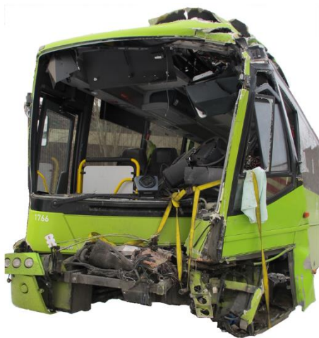
Figur 5: Skader i front på vestgående buss. Foto: SHT
