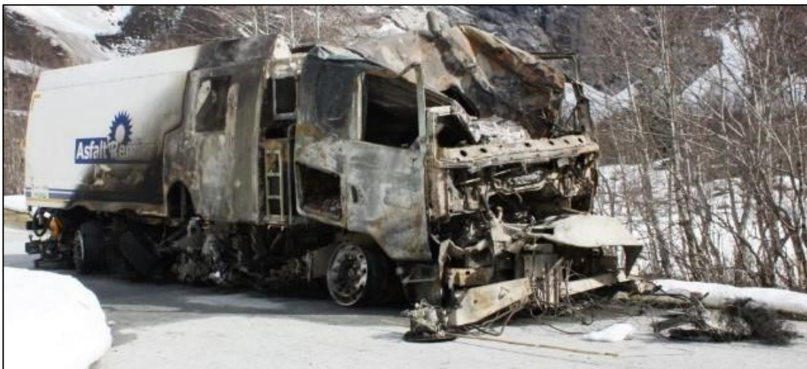
Figur 5: Skadar på den aktuelle feiebilen som følgje av brannen. Feiebilen hadde større brannskadar på høgre enn på venstre side. Foto: Politiet
