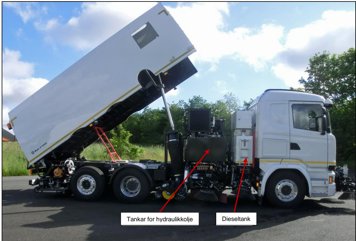
Figur 8: Den aktuelle feiebilen med markerte hydraulikkoljetankar og dieseltank. Foto: Politiet
