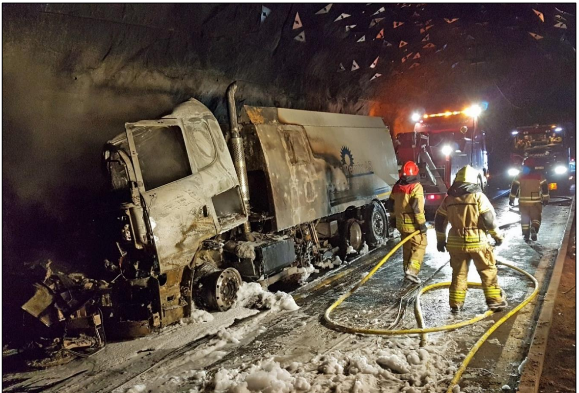
Figur 4: Arbeidet med å sløkkje køyretøybrannen blei sett i verk frå Fjærland-sida av tunnelen. Brannrøyken blei ventilert mot Skei-sida. Foto: Tom Wergeland/Sogn brann og redning IKS
