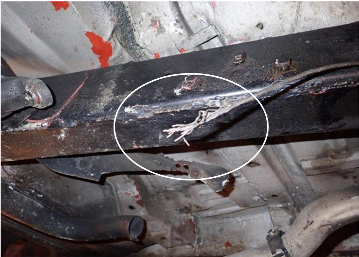
Figur 22: Avrevet vaier for aktivering av parkbremsen. Foto: SHT
