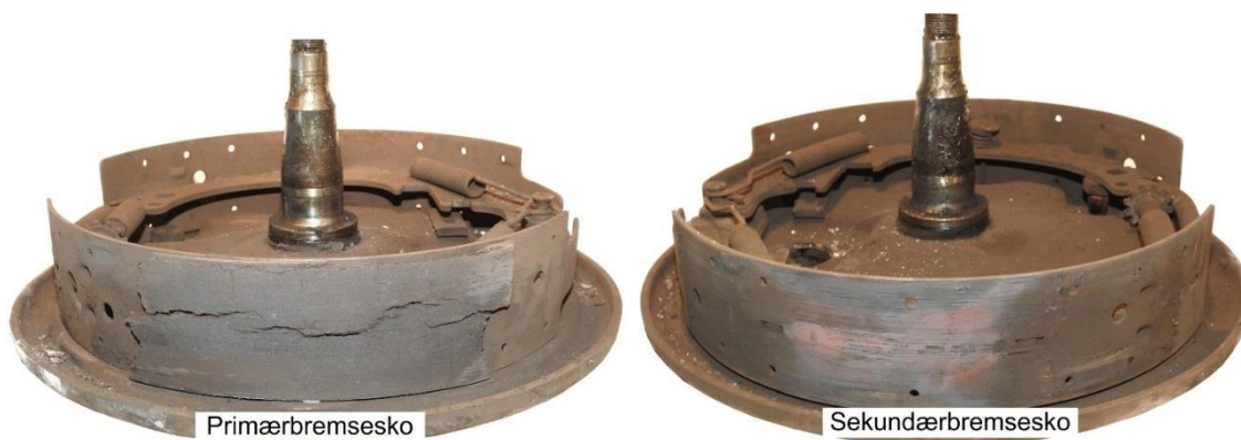
Figur 17: Bremsebånd høyre side foran. Bremsebåndet på sekundærbremseskoen var helt nedslitt. Bremsebåndet på primærbremseskoen var også slitt. Foto: SHT
