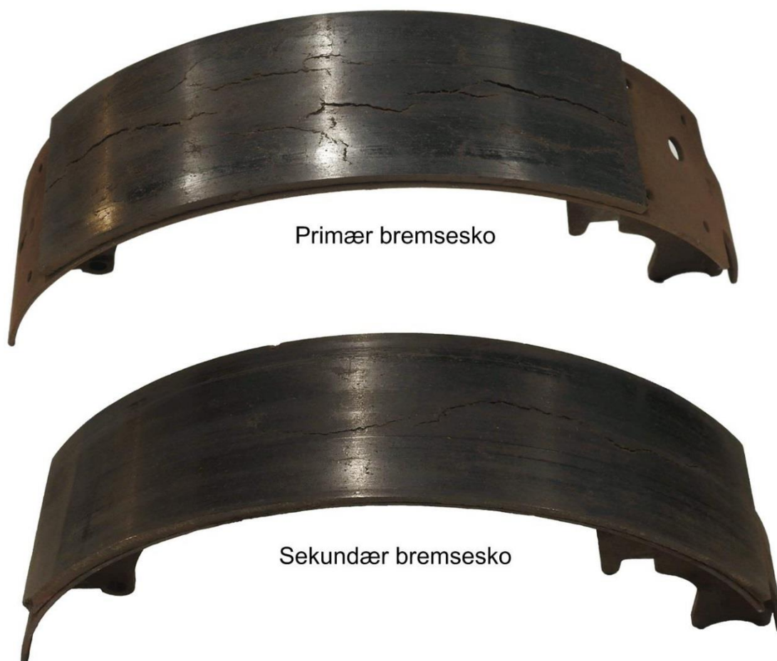
Figur 16: Bremsesko venstre forhjul. Foto: SHT
