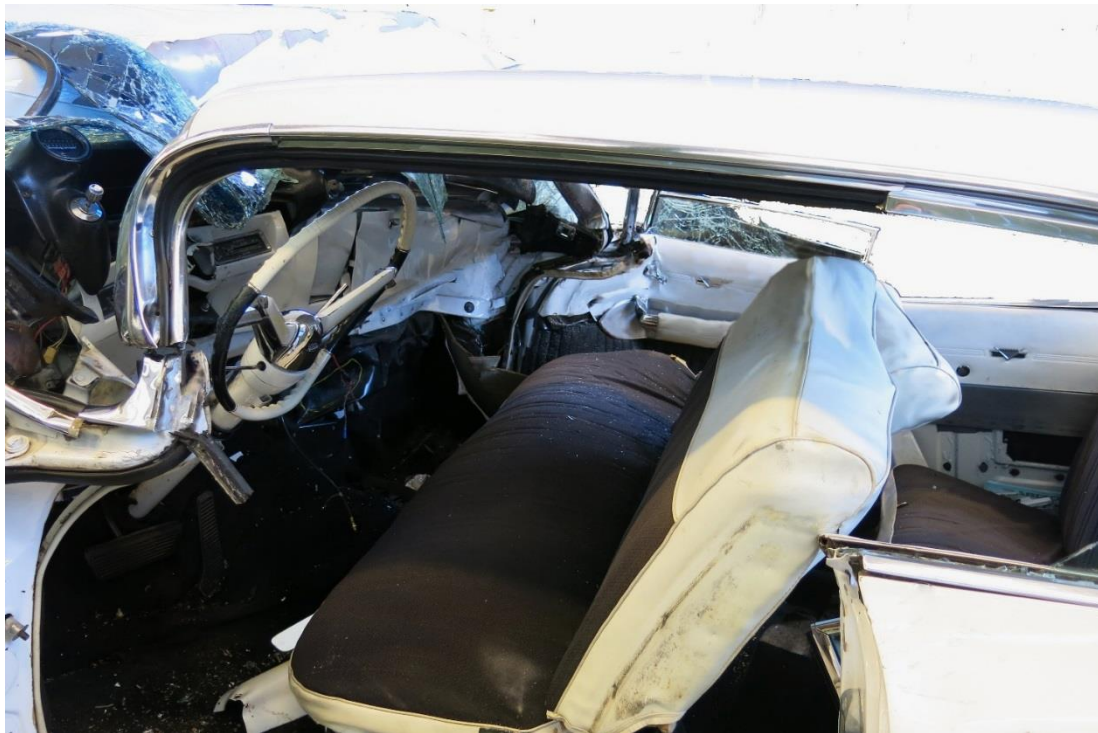
Figur 3: Det var overlevelsesrom i ulykkesbilen både foran og bak etter kollisjonen. Foto: SHT
