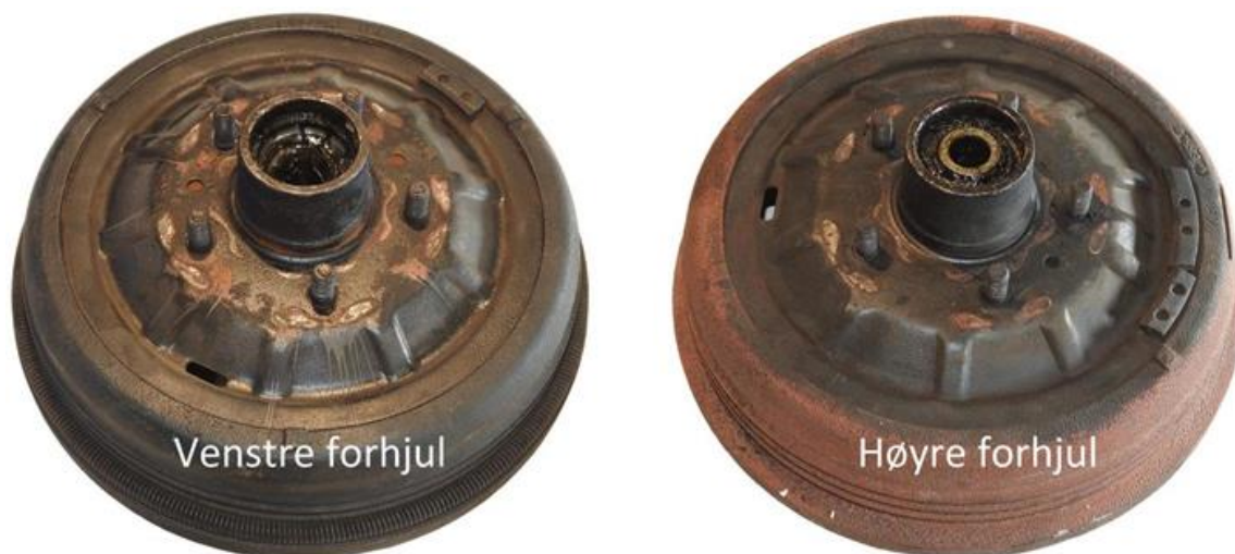
Figur 15: Bremsetromler på bilens forhjul. Foto: SHT
