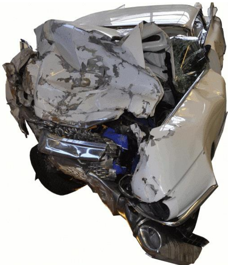
Figur 4: Deformasjon av fronten på ulykkesbilen. Foto: SHT
