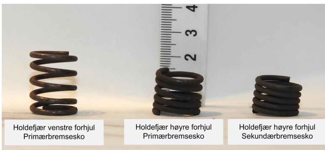
Figur 19: Forskjell i fjærspenn som holder bremse skoene inntil bremse skjoldet. Foto: SHT
