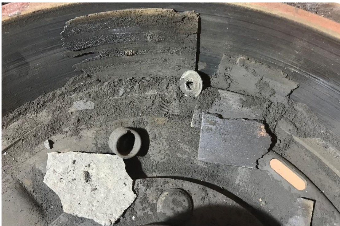
Figur 18: Deler av bremsebånd, bremsestøv og holdefjær innvendig i bremsetrommel på høyre forhjul. Foto: SHT
