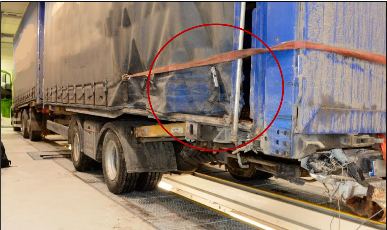
Figur 2: Skader på venstre side av tilhengeren til vogntoget. Rød sirkel markerer treffpunktet med personbilen. Foto: Statens vegvesen
