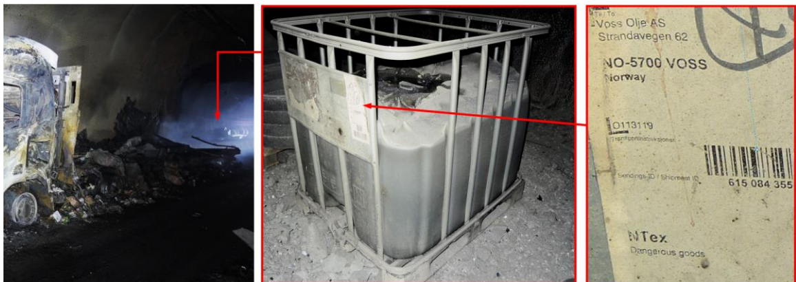
Figur 14: Det utbrende vogntoget og plasseringa til den varmeskadde og umerka IBC-konteinaren med ca. 700 liter frostvæske. Foto: SHK
