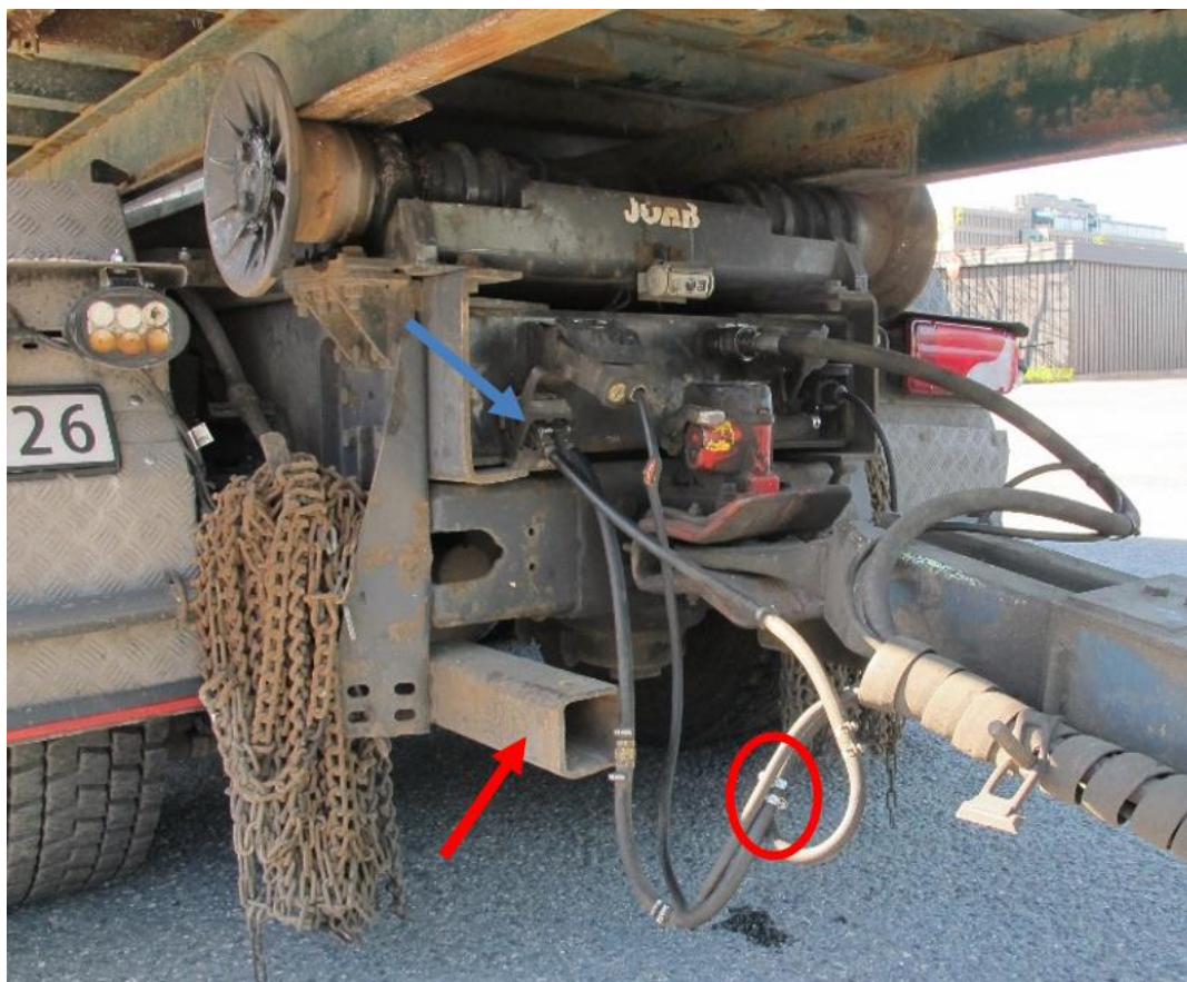
Figur 12: Sammenkobling av komponenter mellom lastebil og tilhenger. Rød sirkel viser området på slangen hvor det oppsto luftlekkasje. Rød pil viser festebrakett til underkjøringshinderet på lastebilen. Foto og illustrasjon: SHK
