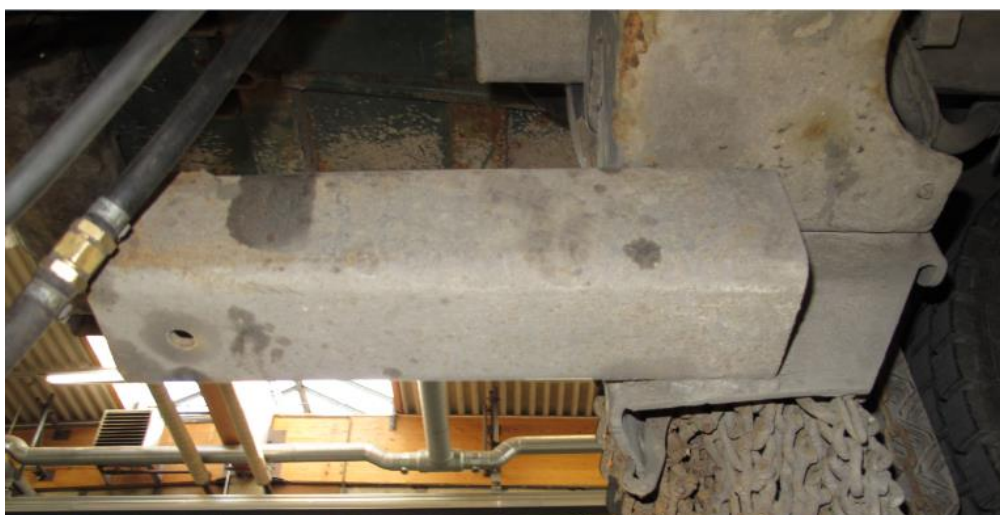
Figur 11: Venstre festebrakett til underkjøringshinder og trykkluftslanger mellom lastebil og tilhenger. Foto: SHK
