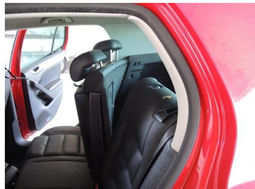
Figur 4: Deformasjonene på høyre del av baksetet når venstre del ble flyttet til låst posisjon. Foto: SHK
