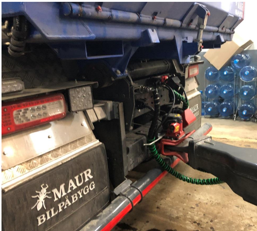
Figur 25: Dagens løsning på beskyttelse og føring for slanger og ledninger mellom bil og tilhenger. Foto: SHK
