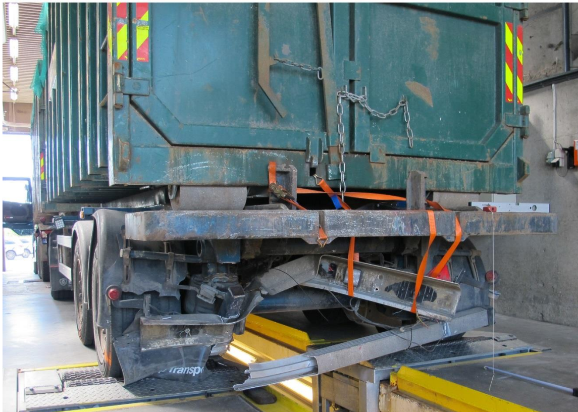
Figur 5: Skader bak på tilhenger. Merker fra Golf i en bredde på 1,4 m fra venstre side. Foto: SHK
