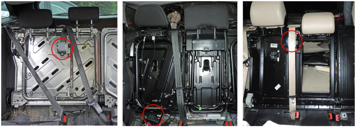
Figur 18: Utforming av bilbeltet integrert i bakseterygg hos ulike produsenter. Beltespolene er markert med rød ring. Illustrasjon: SHK
