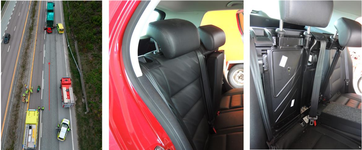
Figur 21: Bøyd baksetekonstruksjon fra påkjøringsulykke mot et stillestående vogntog (SHK, 2020). Kilde: SHK
