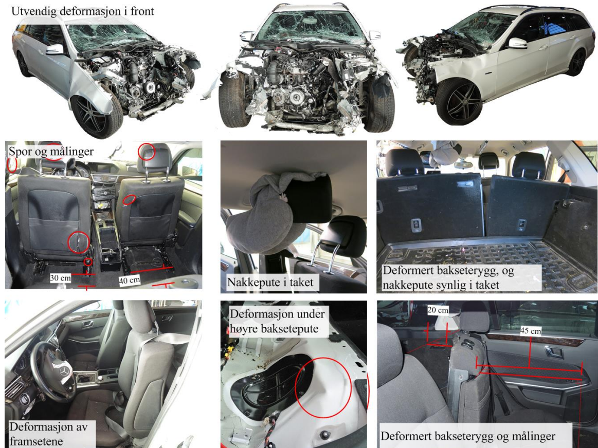
Figur 4: Utvendige og innvendige deformasjoner, spor og treffpunkt i stasjonsvognen. Illustrasjon/foto: SHK
