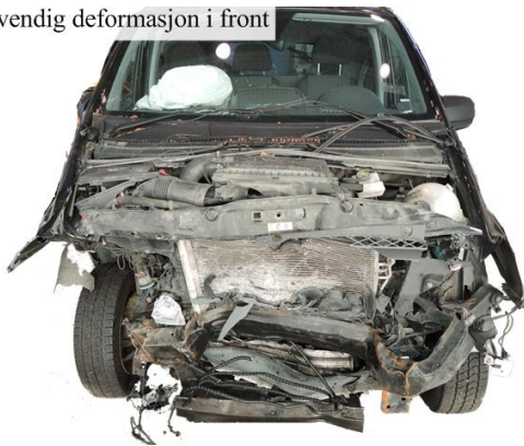
Figur 5: Varebilens utvendige deformasjoner, og kupeen innvendig. Illustrasjon/foto: SHK
