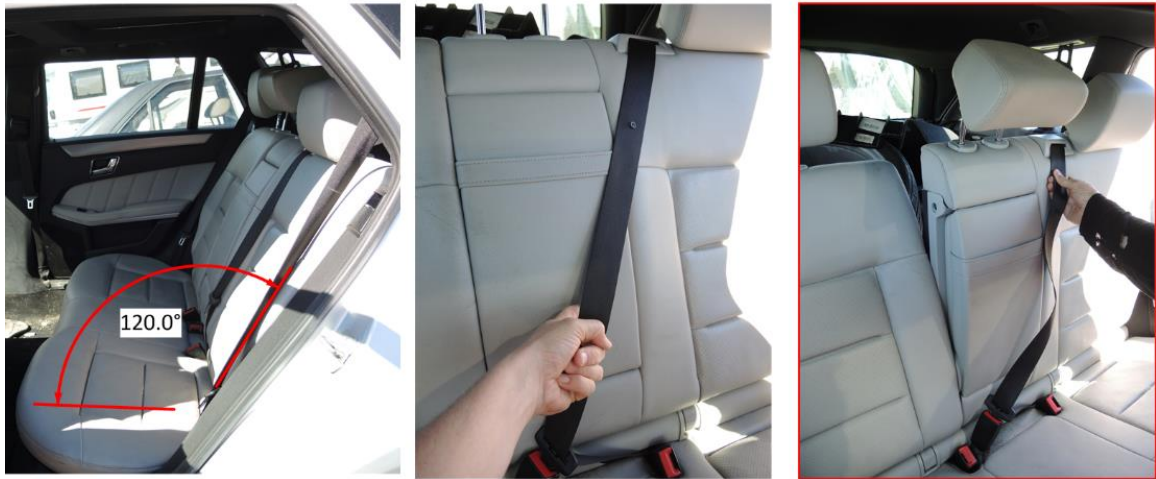
Figur 15: Bakseteryggens vinkel, og forlengelse av låst bilbeltes lengde ved en fremoverbevegelse av seteryggen. Illustrasjon: SHK
