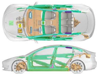
Figur 22: Tesla 3 (2018) har ingen beltestrammere i baksetet. Kilde: Euro Rescue
