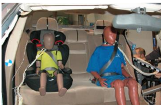
Figur 20: Baksetet i en av testbilene, før og etter test ANEC-testen. Foto: ANEC
