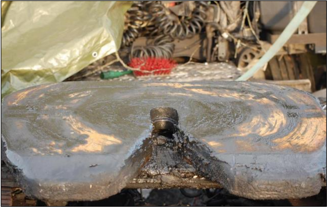
Figur 14: Lyse områder på svingskiven med manglende smørefett. Foto: Statens vegvesen
