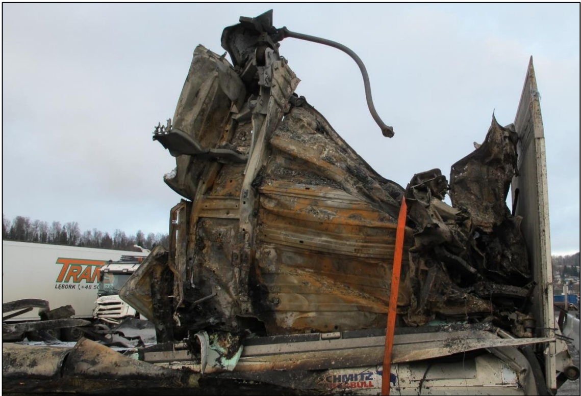
Figur 16: Brannskader på førerhytten til den norske trekkbilen. Foto: SHK
