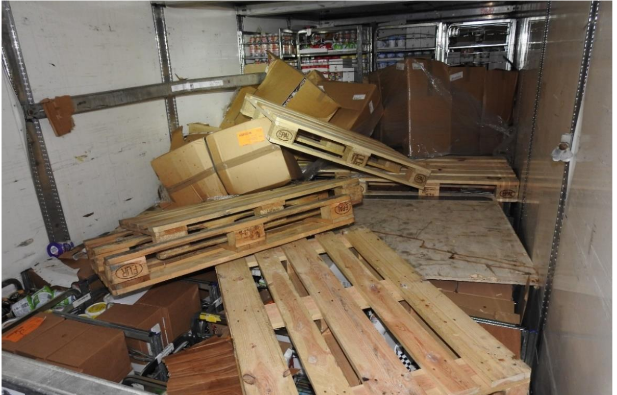
Figur 20: Semitrailerens last og kollapset lastebom. Foto: SHK
