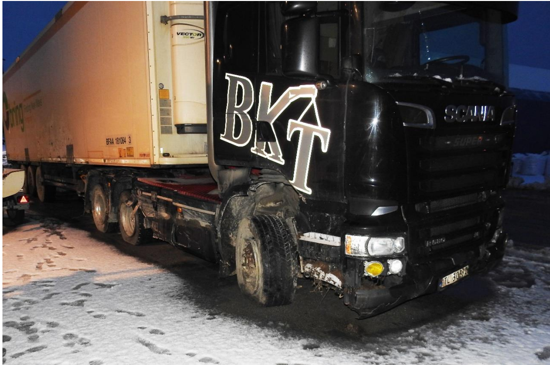
Figur 6: Skader på høyre side av trekkbilen til vogntog C. Foto: SHK
