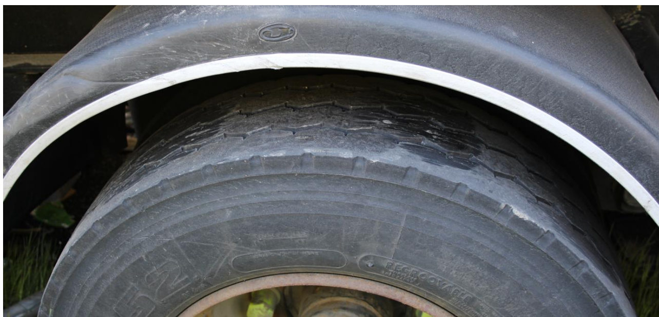
Figur 6: Spor etter bremsebruk i form av mørke område på eitt av dekk til den nest bakerste akslingen på slepvogna til vogntog B. Foto: Statens vegvesen
