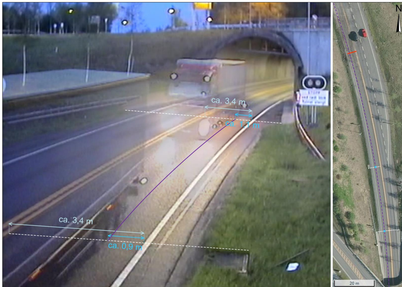
Figur 15: Figuren til venstre er to skjermdumpar (lagde oppå kvarandre) frå opptak gjort av K2 ved ulike tidspunkt. Den lilla linja illustrerer kurva vogntog A følgde i opptaket. Dei kvite stipla linjene er brukt som referanse for å få rette perspektiv til oppmåling ved bruk av projektiv geometri.
